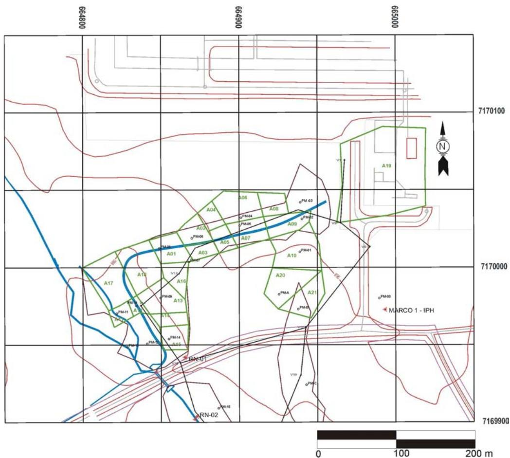
FIGURA 22- Malha utilizada no cálculo de volume de fase livre com dados de outubro de 2000.
