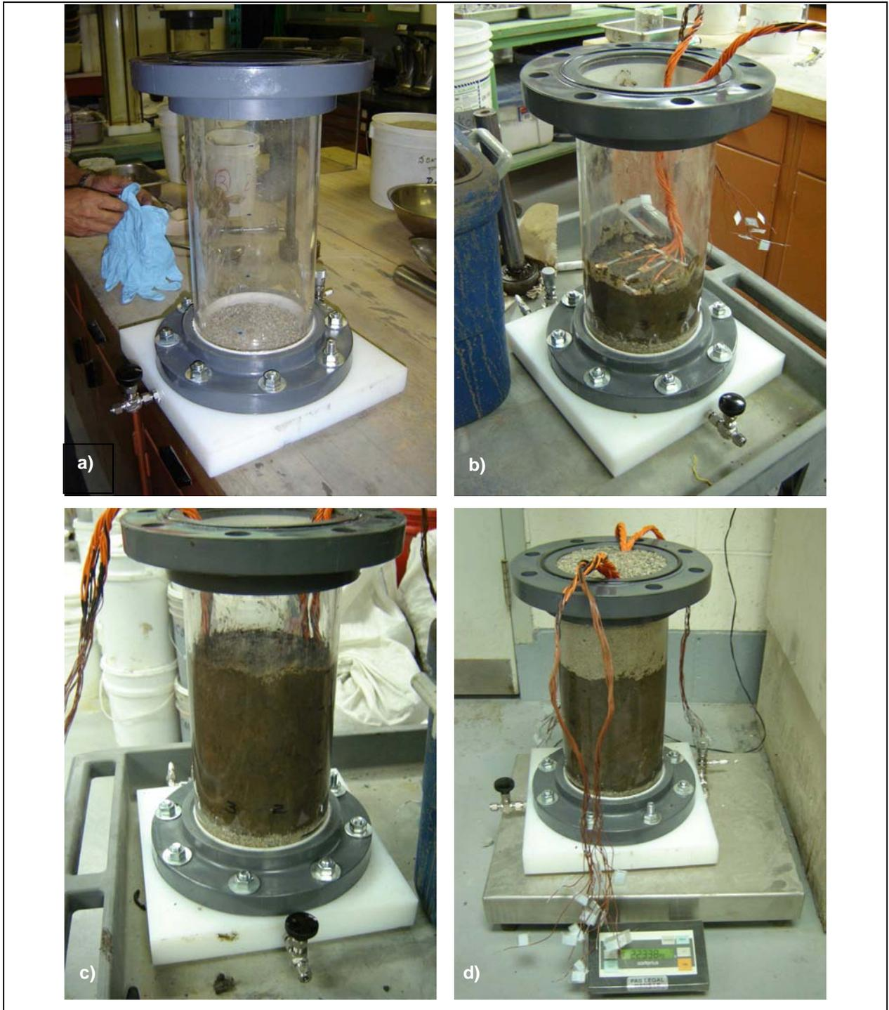
FIGURA 46- Etapas da montagem das colunas: a) introdução da areia no fundo da coluna; b) posicionamento dos eletrodos na argila contaminada; c) preenchimento final com o solo contaminado; d) areia introduzida na extremidade superior da coluna.
