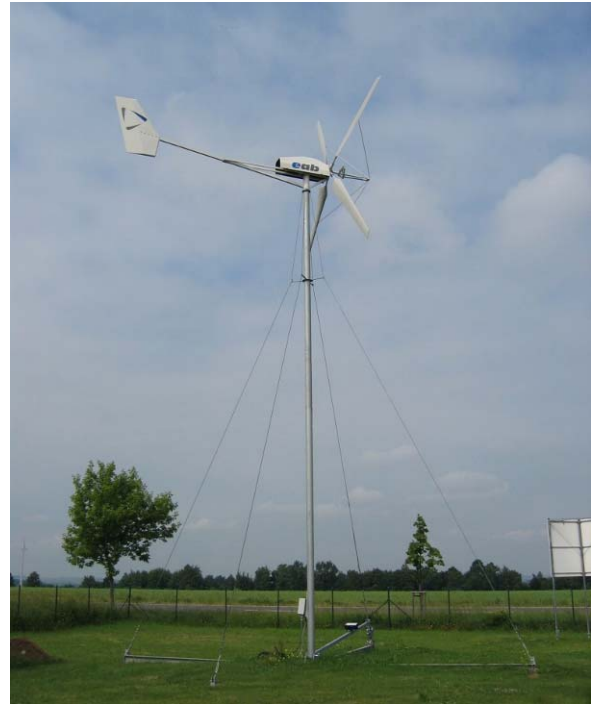
Aerogerador de pequeno porte do tipo Inventus , com potência nominal de 6 kW montado
