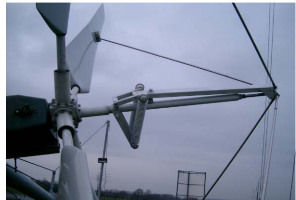
Vista detalhada do dispositivo de controle do ângulo (pitch) das pás do rotor da Inventus
