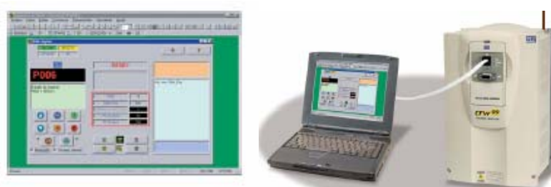
Figura F7: Software SUPERDRIVE, interface serial RS – 232 e cabo de interligação para interface remota Fonte: WEG, 2005.
