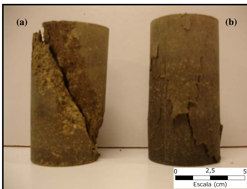
Figura 4.9: Planos de ruptura: (a) 20% de cimento + 2% de contaminante; (b) 10% de cimento + 6% de contaminante.
