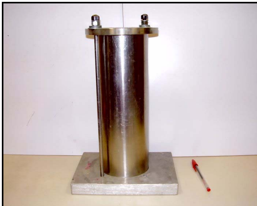
Figura 3.12: Molde cilíndrico utilizado para a moldagem dos ensaios de lixiviação em coluna.
