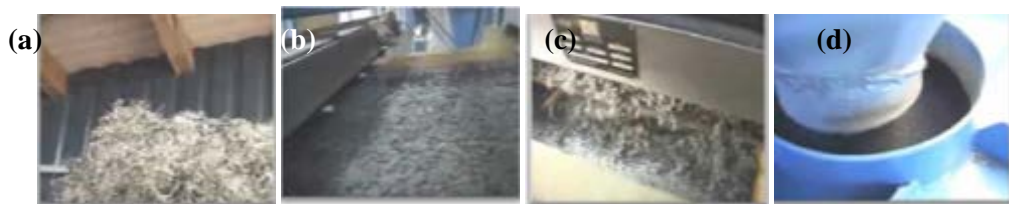
Figura 4: (a) Separação do aço por meio de um eletro-ímã, (b) Separação da borracha – 1º estágio de granulometria, (c) Separação do nylon por peneiramento possibilitando a liberação de borracha com diferentes granulometrias e (d) Grânulos de borracha – última fase do processo de separação.
