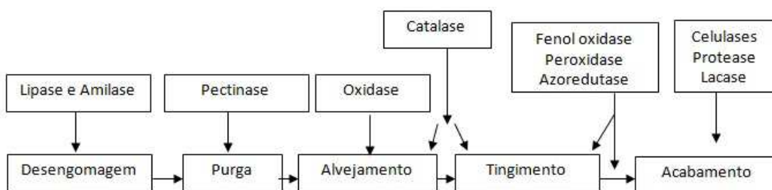
Figura 1 – Beneficiamento químico da indústria têxtil e as enzimas aplicadas. Fonte: Adaptado de Bajpai, 1998, Freitas 2002 & Bon, 2008.
