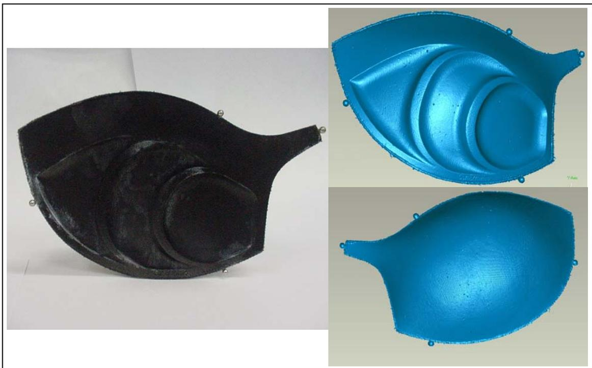
**Figura 46 - Registro de nuvens de pontos através de esferas de referência.
