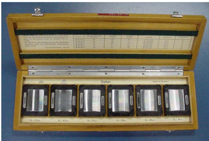
Figura 68 - Padrões de rugosidade da fabricante Massi (Alemanha).
