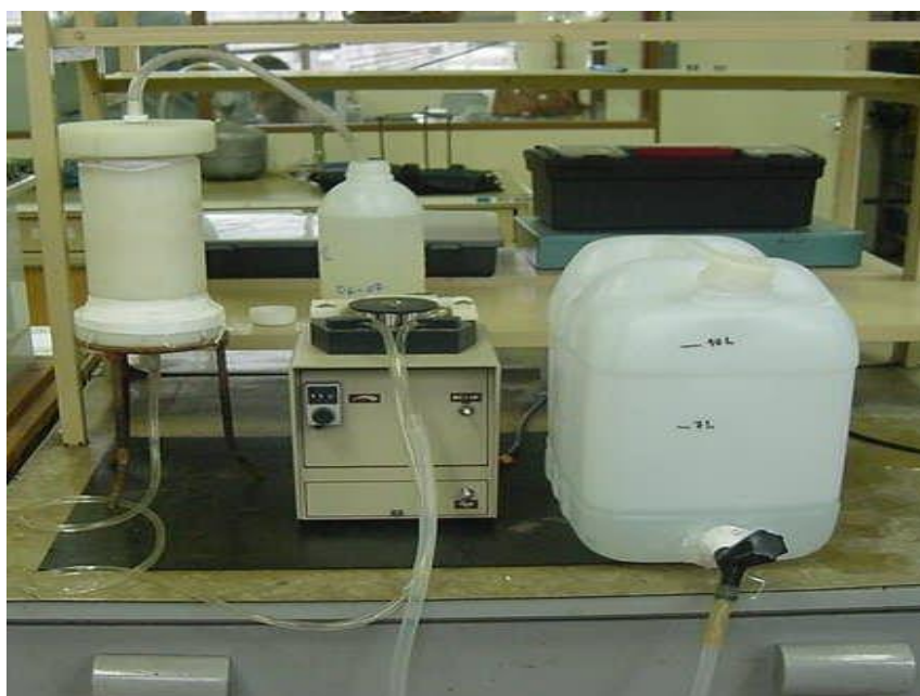
Figura 5 - Processo de lixiviação com coluna.
