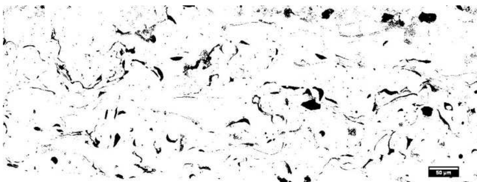
Figura 5.2: Imagem por microscópio óptico, com tratamento de imagem para contrastar claros e escuros para realização da quantificação dos poros. Ampliação de 200x.
