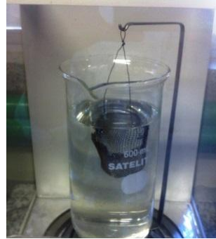
Figura 22 – Sistema para medição de densidade pelo método de Arquimedes.
