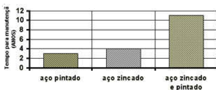
Figura 3. Efeito sinérgico da proteção proporcionada pelo sistema duplex (12).
