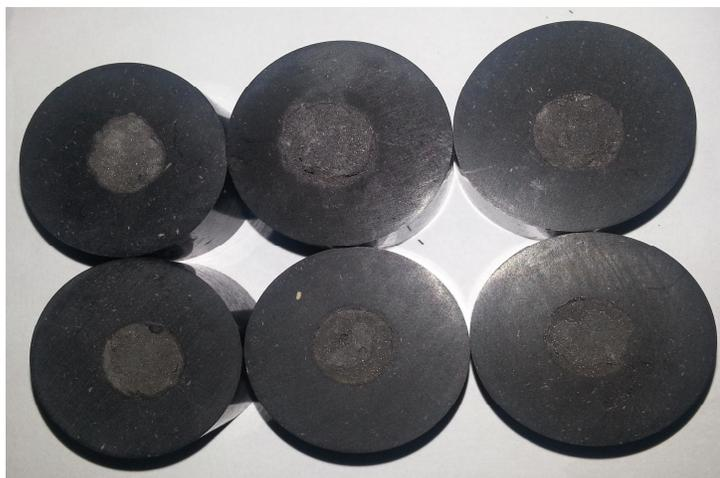
Figura 40: Amostras com 64 horas de moagem sinterizadas
