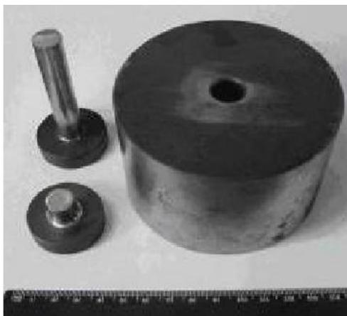
Figura 13: Matriz cilíndrica de compactação.
