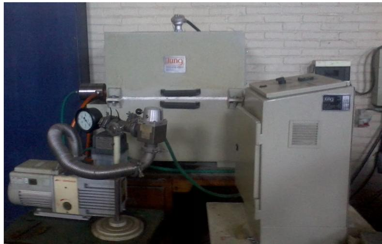
Figura 14: Forno utilizado na sinterização
