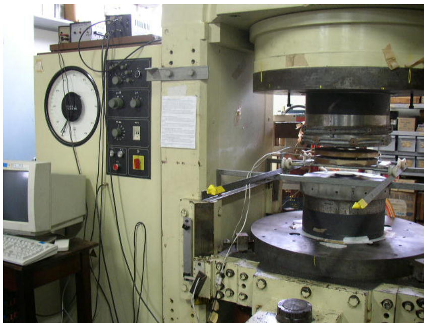
Figura 8. Fotografia da prensa de 1000 tonf do LAPMA IF/UFRGS.
