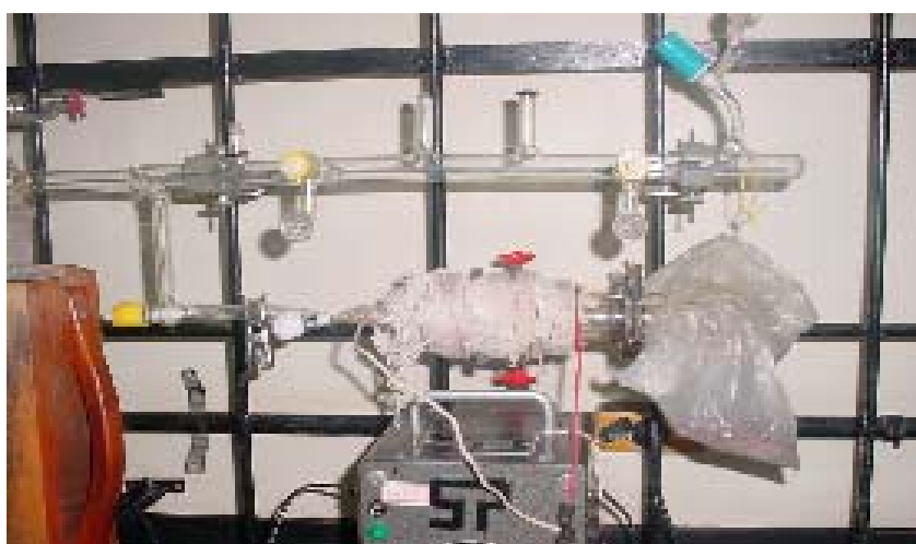
Figura 12- Fotografia da linha de vácuo e da cela utilizada no tratamento térmico das amostras.
