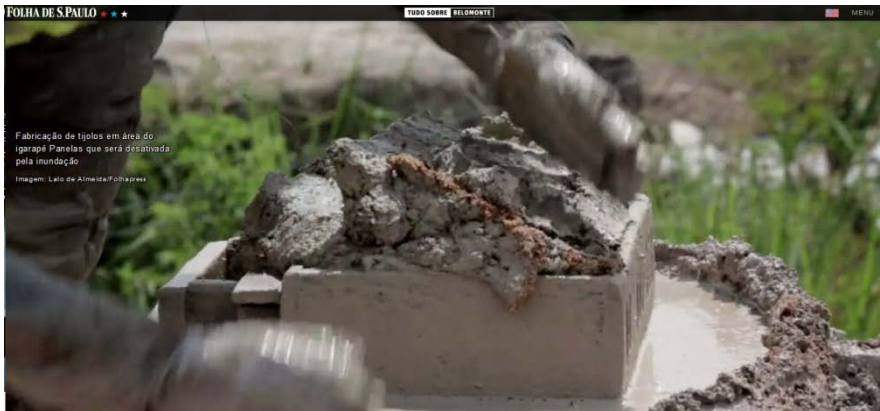
Figura 11 - Vídeo com autoplay , no final do capítulo 3, mostra a fabricação de um tijolo com argila retirada da margem do rio Xingu.
