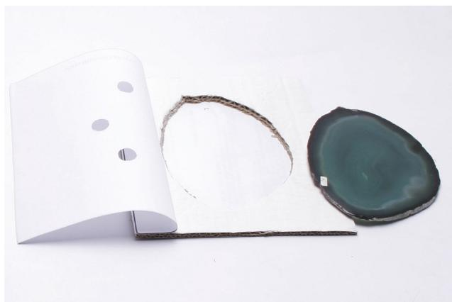
Figura 16: Máscara fixadora da chapa de ágata
