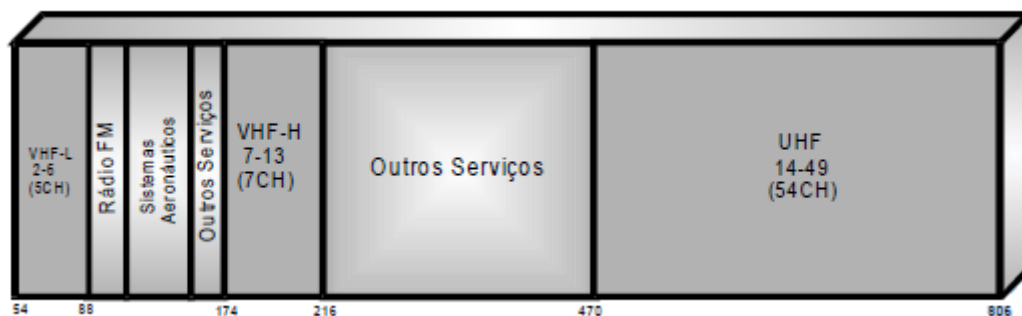
Figura 03 –Espectro de frequência via ar – frequência em MHz
