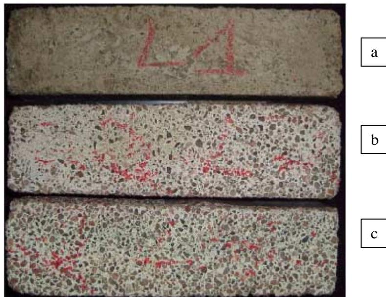
Figura 24: Aspecto dos cp's do material "2 – M", base inorgânica, fabricante A, (a) sem ataque e (b, c) submetidos à solução de ácido láctico. Observou-se que nos primeiros ciclos de agressão houve aumento de massa, somente a partir do 3º ciclo a perda de massa foi verificada, atingindo 3,04% ao final do ensaio.
