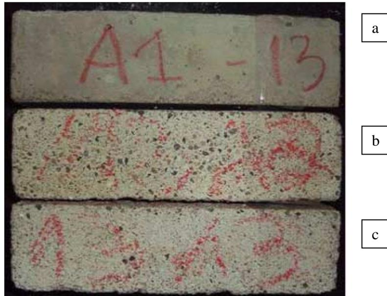
Figura 19: Aspecto dos cp's do material "13 – M", base inorgânica, fabricante E, (a) sem ataque e (b, c) submetidos à solução de ácido acético. Observa-se a remoção da camada superficial dos materiais, deixando os agregados maiores expostos. Este material obteve 5,64 % de perda de massa.
