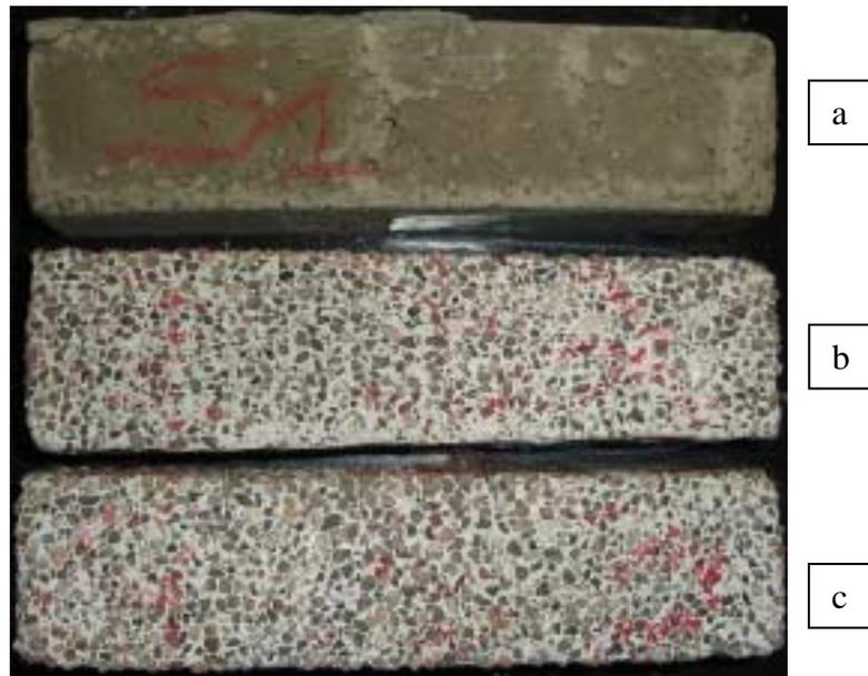
Figura 40: Aspecto dos cp's do material "2 – M", base inorgânica, fabricante A, (a) sem ataque e (b, c) submetidos à solução de ácido sulfúrico. Este material foi o que obteve menor perda de massa, quanto aos materiais de composição inorgânica, sendo 5,28 %.
