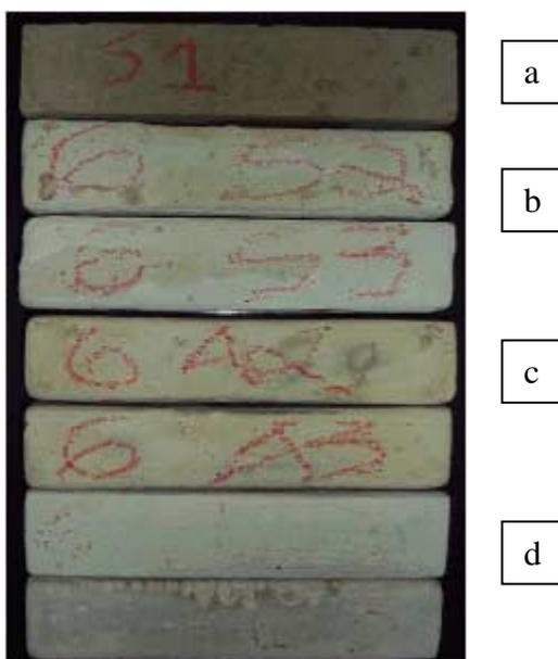
Figura 64: Aspecto dos cp's do material “6 – M”, base inorgânica, fabricante C, (a) referência sem agressão, (b) submetido ao ácido sulfúrico, (c) submetidos ao ácido acético, (d) submetidos ao ácido láctico.
