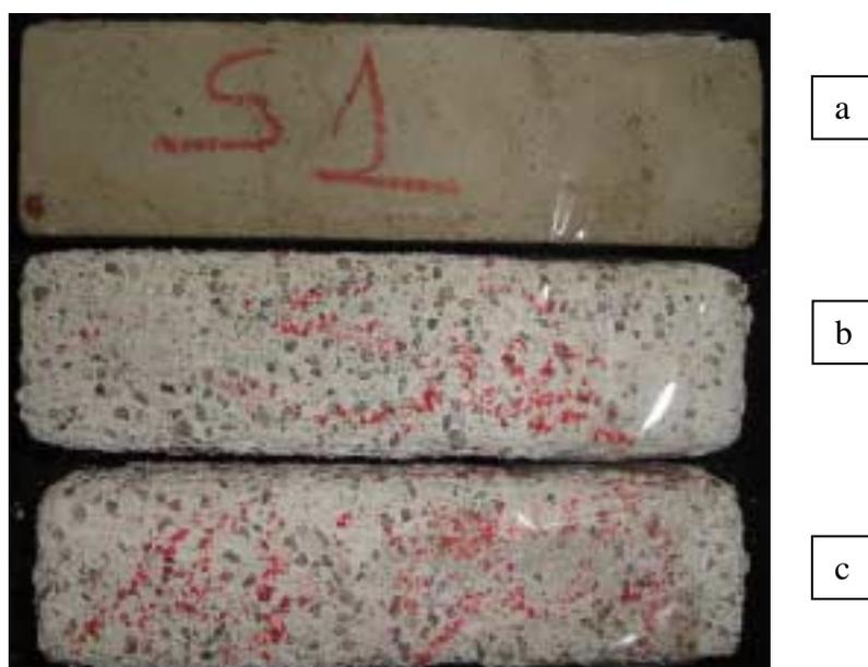
Figura 51: Aspecto dos cp's do material "13 – M", base inorgânica, fabricante E, (a) sem ataque e (b, c) submetidos à solução de ácido sulfúrico. Percebe-se a grande perda de massa pela redução da seção dos cp's submetidos ao ácido sulfúrico. Este material atingiu na média 18,28% de perda de massa.
