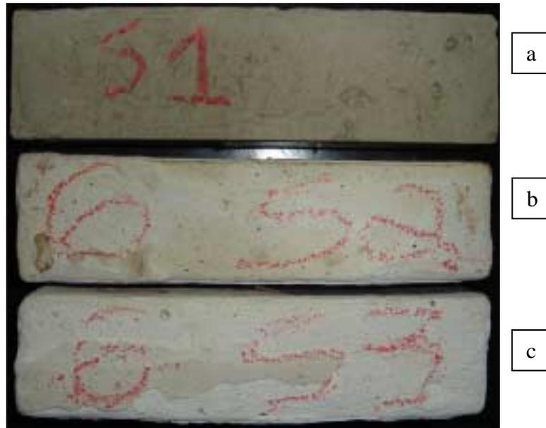
Figura 44: Aspecto dos cp's do material "6 – M", base inorgânica, fabricante C, (a) sem ataque e (b, c) submetidos à solução de ácido sulfúrico. Percebe-se a redução da seção dos cp's, a perda da camada superficial e o lascamento das arestas.
