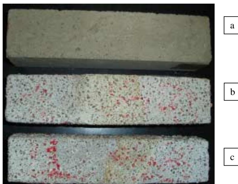
Figura 39: Aspecto dos cp's do material “1 – P”, base mista, fabricante A, (a) sem ataque e (b, c) submetidos à solução de ácido sulfúrico. Percebe-se a redução da seção dos cp's submetidos ao ataque da solução do ácido sulfúrico, sendo removida a camada superficial e observando-se a exposição dos agregados maiores.
