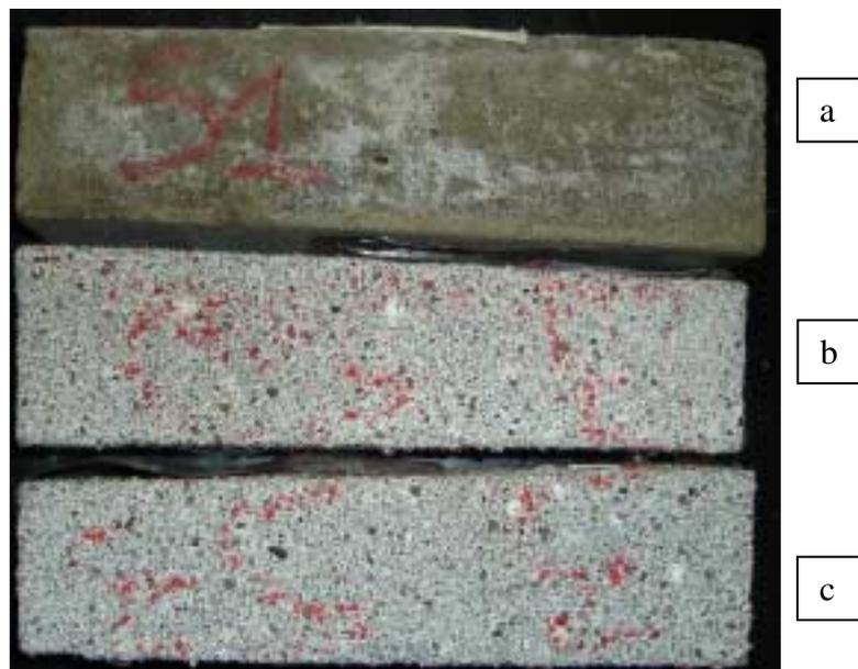
Figura 41: Aspecto dos cp's do material "3 – M", base inorgânica, fabricante B, (a) sem ataque e (b, c) submetidos à solução de ácido sulfúrico. Observa-se a redução da seção dos cp's submetidos à agressão ácida. Este foi o material de base inorgânica que teve maior perda de massa, ultrapassando 20 % da massa inicial.
