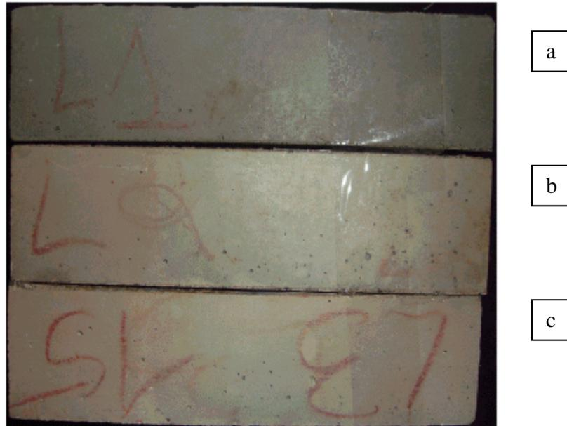
Figura 37: Aspecto dos cp's do material “**15 – E**”, base orgânica, fabricante E, (a) sem ataque e (b, c) submetidos à solução de ácido láctico. Este material manteve-se íntegro ao longo dos 5 ciclos de agressão, alterando apenas sua coloração.
