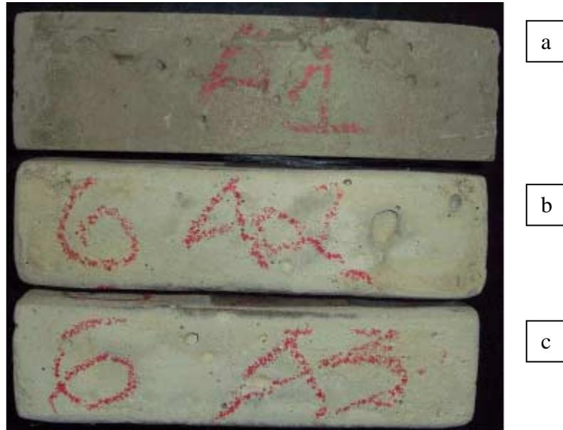
Figura 12: Aspecto dos cp's do material "6 - M", base inorgânica, fabricante C, (a) sem ataque e (b, c) submetidos à solução de ácido acético. Observa-se claramente a redução da seção dos cp's submetidos ao ataque do ácido acético, os quais tiveram perda de massa maior que 10 %.
