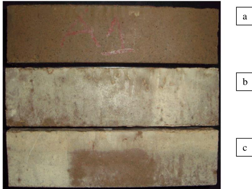
Figura 27: Aspecto dos cp's do material "5 – E", base orgânica, fabricante B, (a) sem ataque e (b, c) submetidos à solução de ácido láctico. Este material manteve-se íntegro ao longo dos 5 ciclos de agressão, alterando apenas sua coloração.
