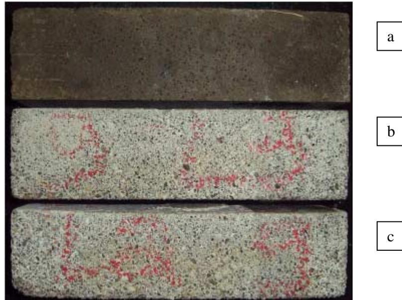
Figura 31: Aspecto dos cp's do material "9 – M", base inorgânica, fabricante D, (a) sem ataque e (b, c) submetidos à solução de ácido láctico. Este material foi o que obteve maior perda de massa, quanto à agressão do ácido láctico, comparando com os materiais de mesma composição química.
