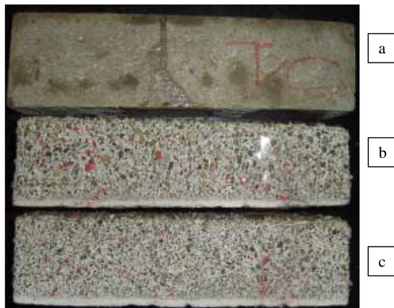
Figura 47: Aspecto dos cp's do material "9 – M", base inorgânica, fabricante D, (a) sem ataque e (b, c) submetidos à solução de ácido sulfúrico. Verifica-se a redução da seção dos cp's e a exposição dos agregados maiores.
