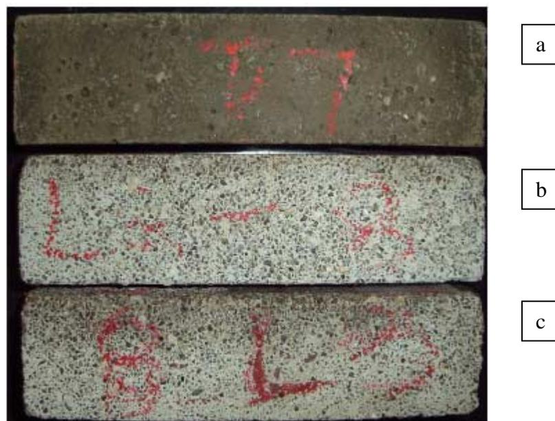
Figura 30: Aspecto dos cp's do material "8 - M", base inorgânica, fabricante C, (a) sem ataque e (b, c) submetidos à solução de ácido láctico. Este material foi o que obteve menor perda de massa, quanto à agressão do ácido láctico, comparando com os materiais de mesma composição química.
