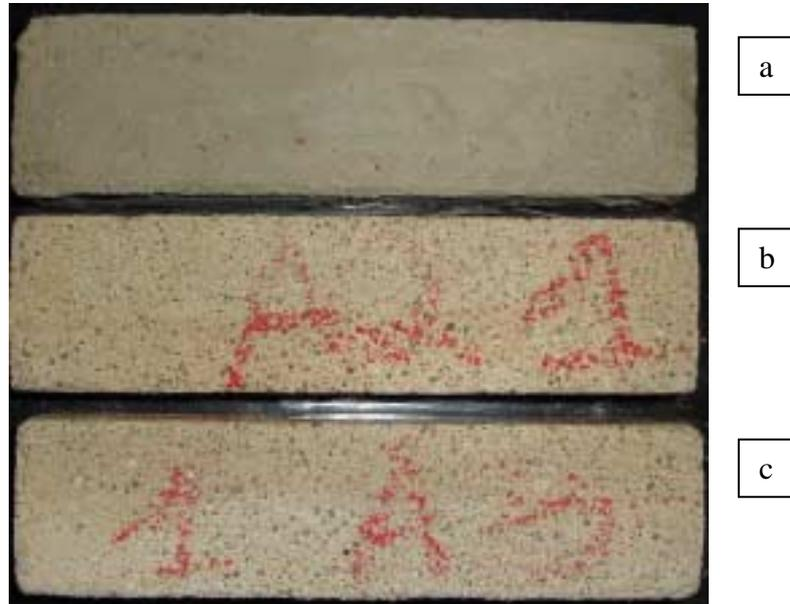
Figura 7: Aspecto dos cp's do material "1 - P", base mista, fabricante A, (a) sem ataque e (b, c) submetidos à solução de ácido acético. Observa-se a perda da camada superficial e o aparecimento dos agregados maiores
