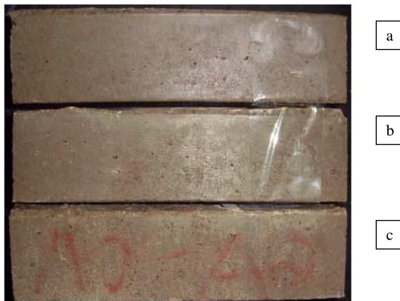
Figura 16: Aspecto dos cp's do material "10 – E", base orgânica, fabricante D, (a) sem ataque e (b, c) submetidos à solução de ácido acético. Observa-se a integridade dos cp's submetidos ao ataque ácido.
