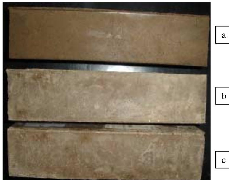
Figura 43: Aspecto dos cp's do material "5 – E", base orgânica, fabricante B, (a) sem ataque e (b, c) submetidos à solução de ácido sulfúrico. Os cp's submetidos ao ataque ácido mantiveram-se íntegros ao longo dos 5 ciclos de agressão ácida.
