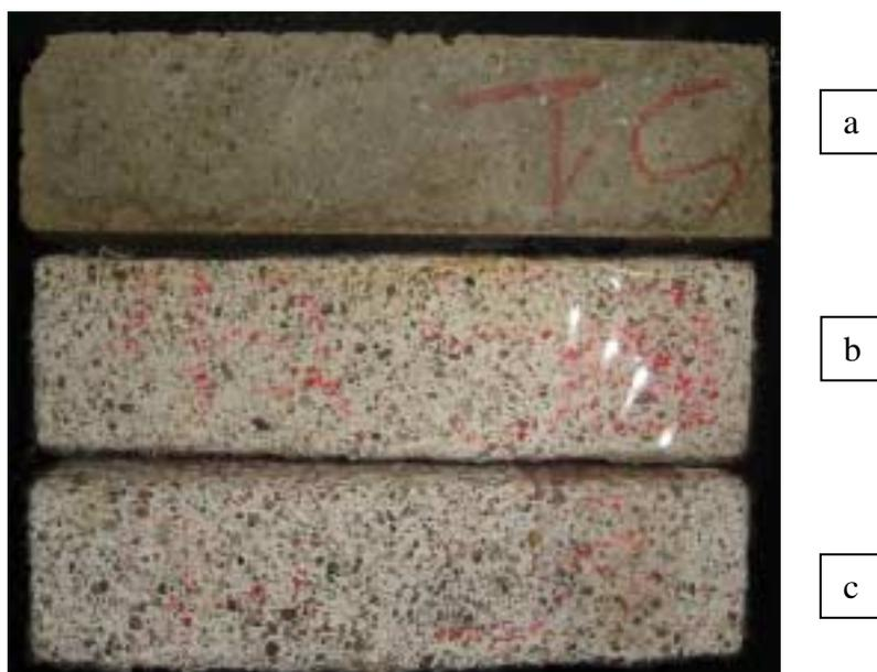
Figura 50: Aspecto dos cp's do material "12 – M", base inorgânica, fabricante D, (a) sem ataque e (b, c) submetidos à solução de ácido sulfúrico. Verifica-se a redução da seção dos cp's e a exposição dos agregados maiores.
