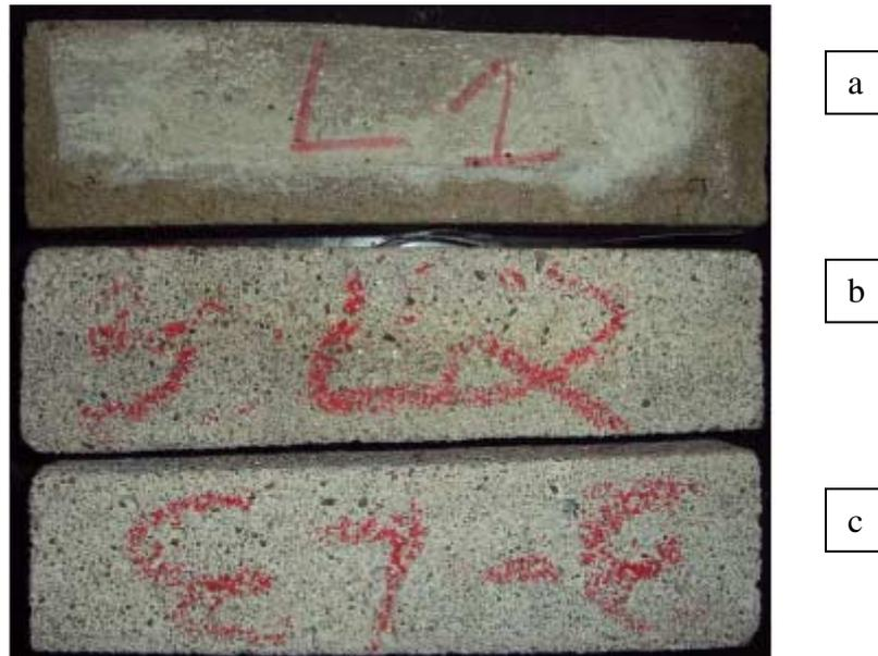
Figura 25: Aspecto dos cp's do material "3 – M", base inorgânica, fabricante B, (a) sem ataque e (b, c) submetidos à solução de ácido láctico. No 1º ciclo de agressão houve incremento de massa. A partir do 2º ciclo o material foi perdendo a camada superficial, deixando os agregados maiores visíveis.
