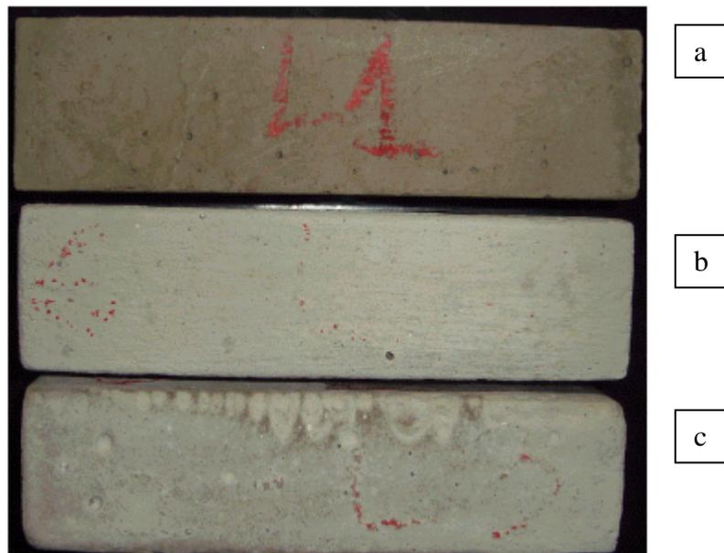
Figura 28: Aspecto dos cp's do material "6 – M", base inorgânica, fabricante C, (a) sem ataque e (b, c) submetidos à solução de ácido láctico. Inicialmente este material teve aumento de massa, a partir do 3º ciclo verificou-se a redução da seção dos cp's.
