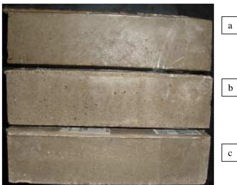
Figura 48: Aspecto dos cp's do material “10 – E”, base orgânica, fabricante D, (a) sem ataque e (b, c) submetidos à solução de ácido sulfúrico. Este material manteve-se íntegro ao longo dos 5 ciclos de agressão ácida.
