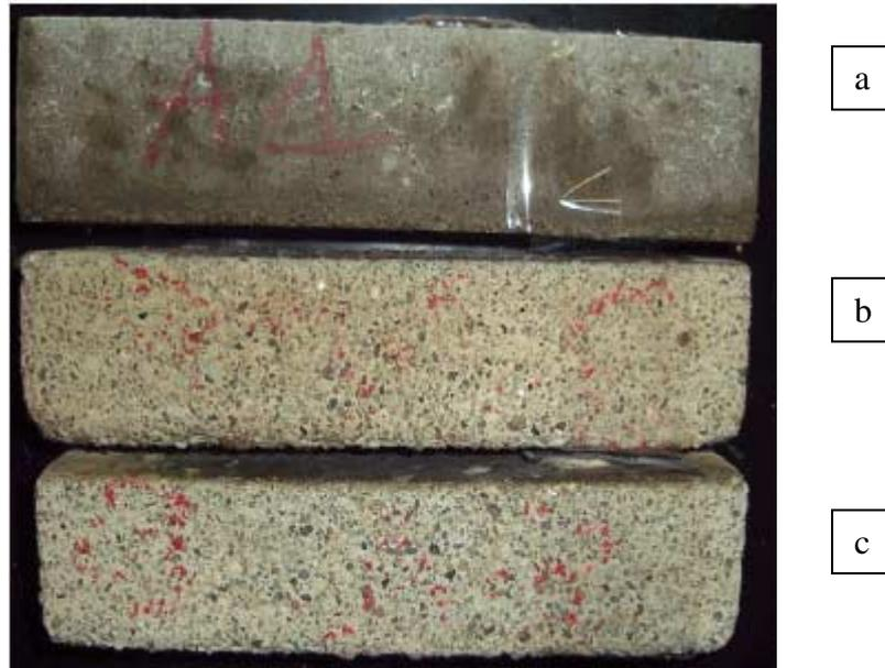
Figura 15: Ataque pela solução de ácido acético. Aspecto dos cp's do material "9 – M", base inorgânica, fabricante D, (a) sem ataque e (b, c) submetidos à solução de ácido acético. Este material teve grande perda de massa, atingindo 8,22 % da massa inicial.
