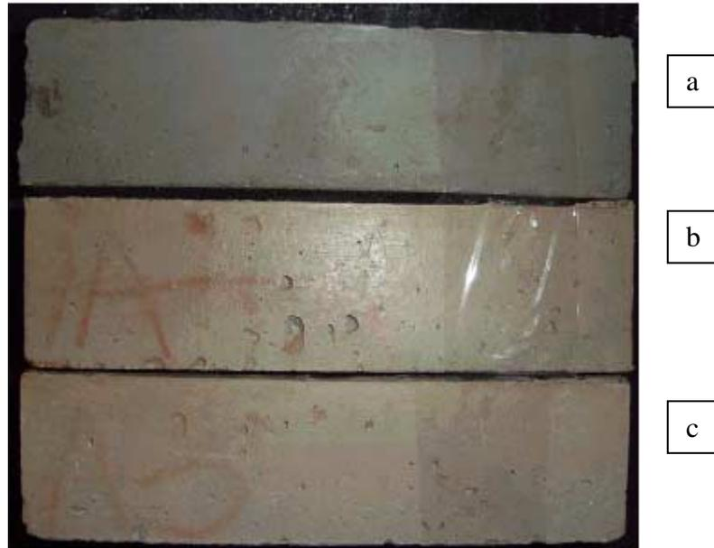
Figura 21: Aspecto dos cp's do material "15 – E", base orgânica, fabricante E, (a) sem ataque e (b, c) submetidos à solução de ácido acético. Observa-se a integridade dos cp's após os 5 ciclos de ataque ácido. Este material de base orgânica obteve na média quase 0,20 % de aumento de massa
