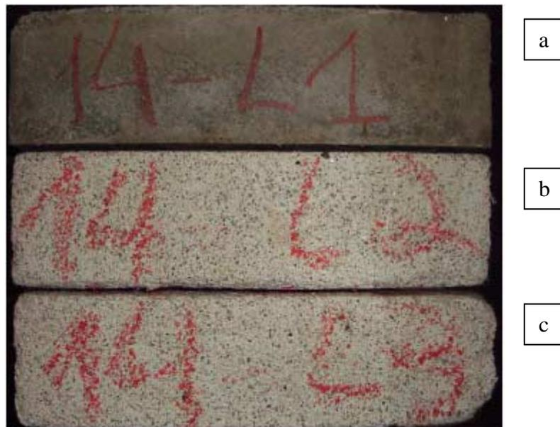
Figura 36: Aspecto dos cp's do material “14 – P”, base mista, fabricante E, (a) sem ataque e (b, c) submetidos à solução de ácido láctico. Percebe-se ainda a existência da camada superficial notando-se o aparecimento superficial dos agregados maiores.
