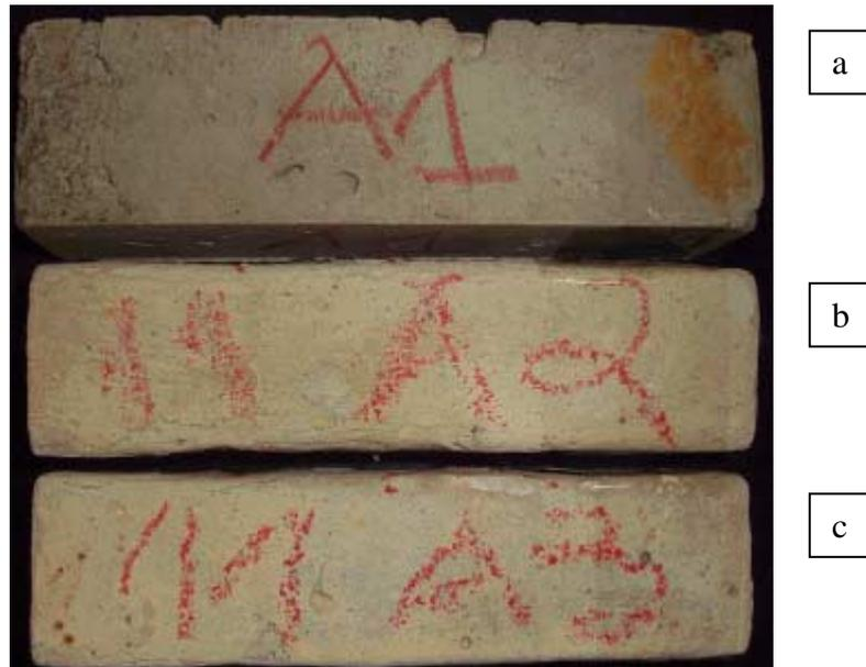
Figura 17: Aspecto dos cp's do material "11 - P", base mista, fabricante D, (a) sem ataque e (b, c) submetidos à solução ácida. Observa-se a redução da seção dos cp's submetidos à solução do ácido acético, conseqüentemente grande perda de massa. Este material foi o que obteve maior perda de massa de todos os materiais analisados, 14,75%.
