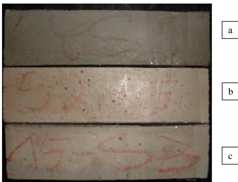
Figura 53: Aspecto dos cp's do material "15 – E", base orgânica, fabricante E, (a) sem ataque e (b, c) submetidos à solução de ácido sulfúrico. Percebe-se a integridade dos cp's submetidos ao ataque ácido, alterando apenas sua coloração.
