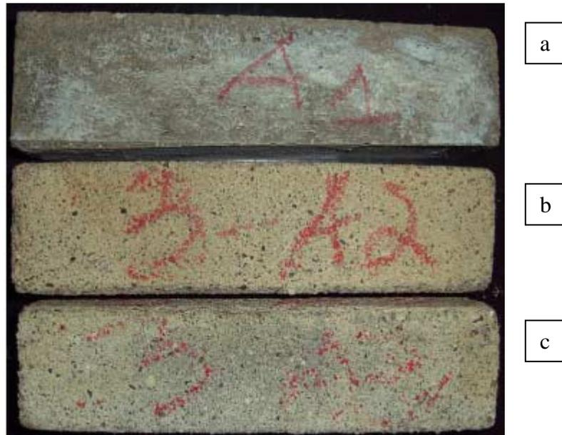
Figura 9: Aspecto dos cp's do material "3 – M", base inorgânica, fabricante B, (a) sem ataque e (b, c) submetidos à solução de ácido acético. Observa-se que os cp's submetidos à solução do ácido acético tiveram pouca perda de massa, nota-se ainda a camada superficial que foi pouco removida
