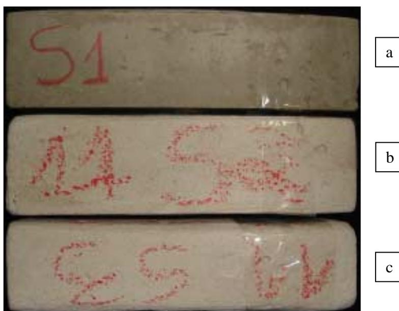
Figura 49: Aspecto dos cp's do material “11 – P”, base mista, fabricante D, (a) sem ataque e (b, c) submetidos à solução de ácido sulfúrico. Este material foi o que obteve menor perda de massa , comparados com os materiais de composição similar, atingindo 4,99%.
