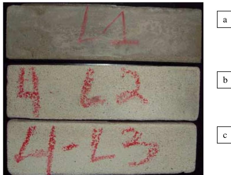
Figura 26: Aspecto dos cp's do material "4 – P", base mista, fabricante B, (a) sem ataque e (b, c) submetidos à solução de ácido láctico. Este material teve boa resistência ao ataque da solução do ácido láctico, atingindo apenas 1,51 % de perda de massa ao final dos 5 ciclos de agressão
