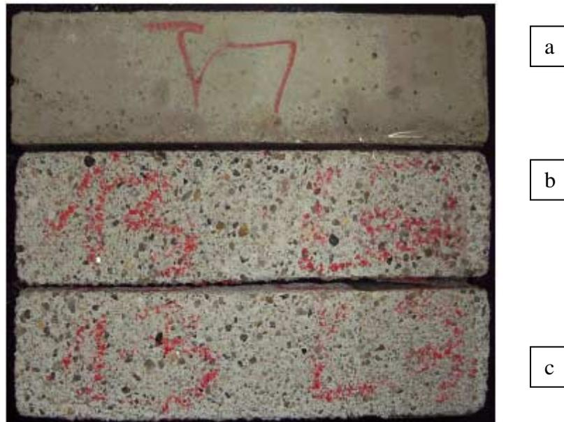
Figura 35: Aspecto dos cp's do material “13 – M”, base inorgânica, fabricante E, (a) sem ataque e (b, c) submetidos à solução de ácido láctico. Percebe-se a exposição dos agregados maiores nos cp's submetidos ao ataque da solução ácida, a camada superficial foi removida devido ao ataque da solução de ácido láctico.
