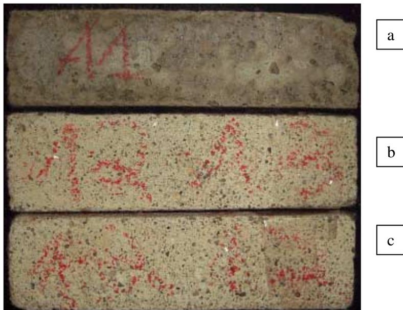
Figura 18: Aspecto dos cp's do material "12 - M", base inorgânica, fabricante D, (a) sem ataque e (b, c) submetidos à solução de ácido acético. A perda de massa dos cp's submetidos ao ataque ácido foi quanto a remoção da camada superficial, com pouca diminuição da seção.
