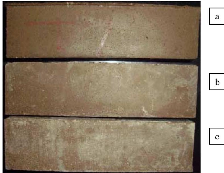
Figura 11: Aspecto dos cp's do material "5 - E", base orgânica, fabricante B, (a) sem ataque e (b, c) submetidos à solução de ácido acético. Percebe-se a integridade dos materiais submetidos ao ataque ácido, observando-se somente mudança na coloração.
