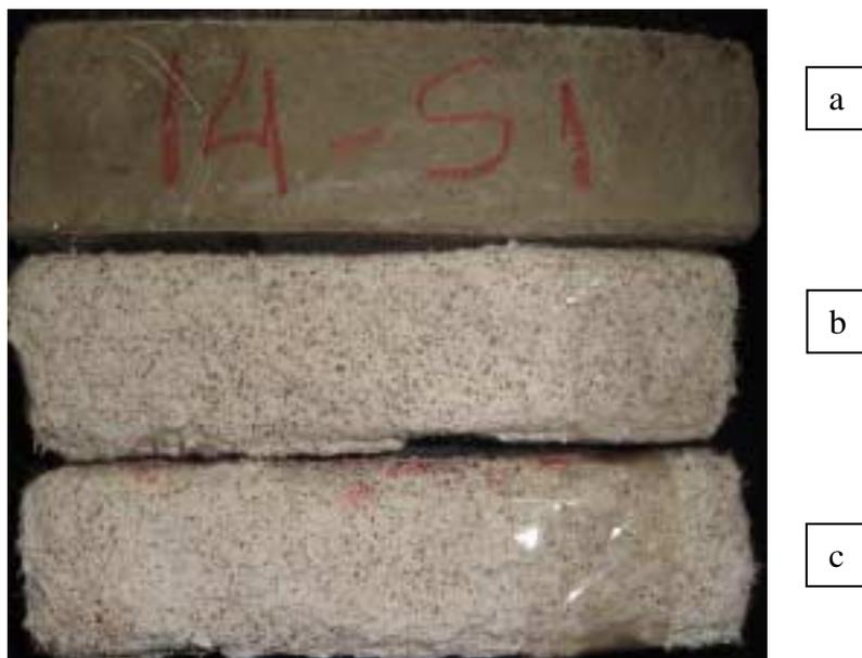
Figura 52: Aspecto dos cp's do material "14 – P", base mista, fabricante E, (a) sem ataque e (b, c) submetidos à solução de ácido sulfúrico. Observa-se a deterioração dos cp's agredidos pela solução ácida. Este material foi o material de base mista que obteve maior perda de massa, 25,27%.
