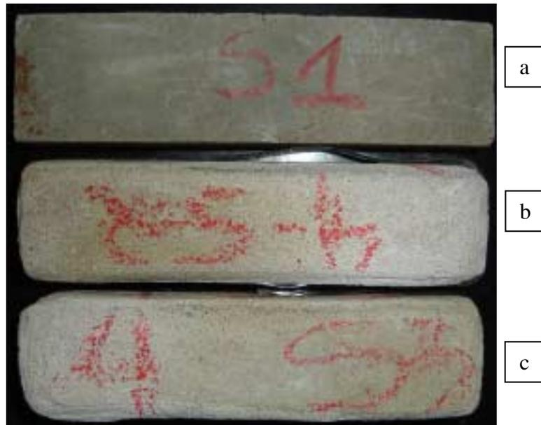
Figura 42: Aspecto dos cp's do material "4 – P", base mista, fabricante B, (a) sem ataque e (b, c) submetidos à solução de ácido sulfúrico. Percebe-se a redução da seção dos cp's e o lascamento das arestas.
