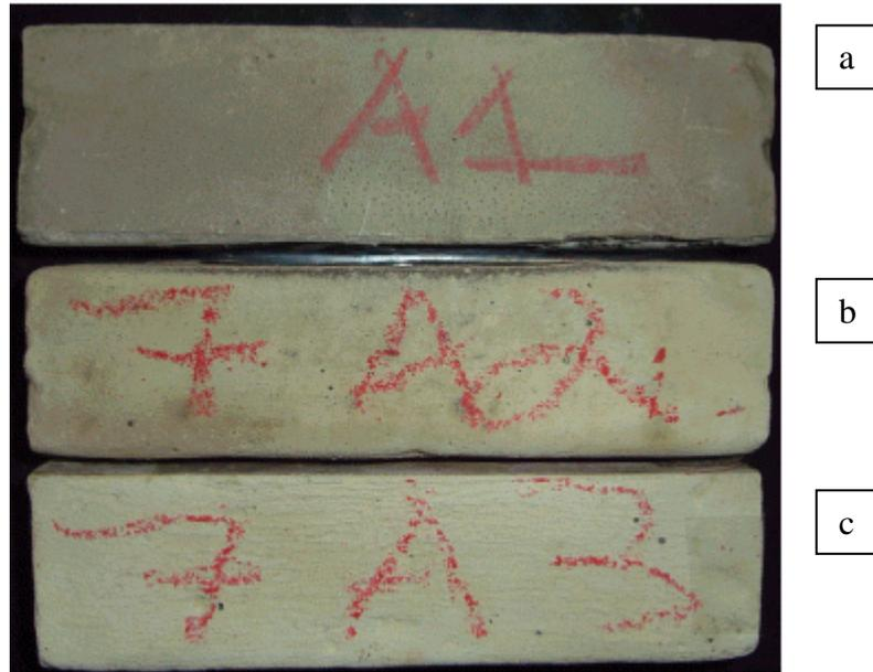
Figura 13: Aspecto dos cp's do material "7 - P", base mista, fabricante C. (a) sem ataque e (b, c) submetidos à solução de ácido acético. Esta argamassa contém fibras sintéticas em sua composição. Percebe-se a porosidade dos cp's, sendo prejudicial para perda de massa.
