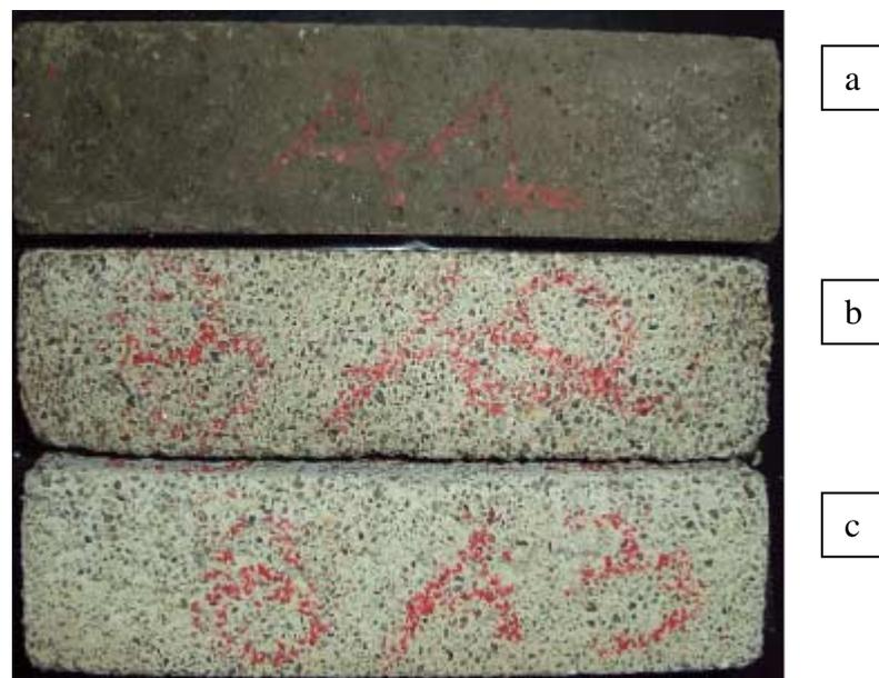
Figura 14: Aspecto dos cp's do material "8 - M", base inorgânica, fabricante C. (a) sem ataque e (b, c) submetidos à solução de ácido acético. Percebe-se a exposição dos agregados maiores nos cp's submetidos ao ataque da solução ácida. A camada superficial da pasta foi agredida pela solução e conseqüentemente removida.
