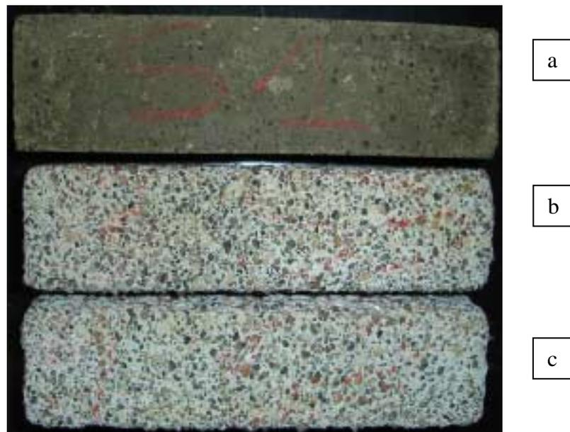
Figura 46: Aspecto dos cp's do material "8 – M", base inorgânica, fabricante C, (a) sem ataque e (b, c) submetidos à solução de ácido sulfúrico. Percebe-se a remoção da camada superficial, ficando os agregados maiores expostos.
