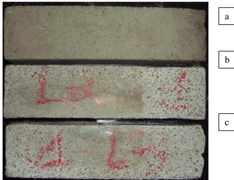
Figura 23: Aspecto dos cp's do material "1 – P", base mista, fabricante A, (a) sem ataque e (b, c) submetidos à solução de ácido láctico. Os cp's submetidos ao ataque do ácido láctico inicialmente tiveram incremento de massa, a partir do 3º ciclo de agressão ácida foi observada a redução da massa. Este material foi o que obteve menor perda de massa, em relação ao ataque do ácido láctico
