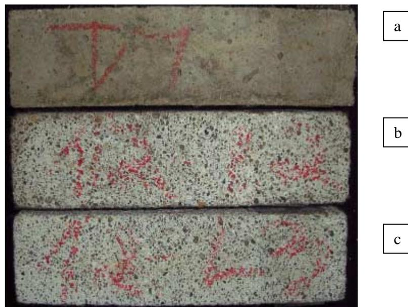
Figura 34: Aspecto dos cp's do material "12 – M", base inorgânica, fabricante D, (a) sem ataque e (b, c) submetidos à solução de ácido láctico. Observa-se a perda da camada superficial dos cp's ficando os agregados maiores expostos.
