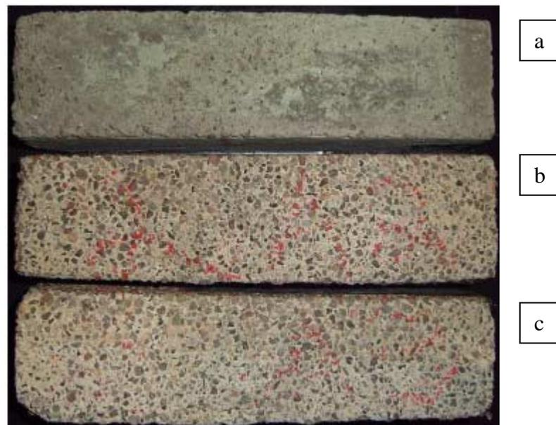
Figura 8: Aspecto dos cp's do material "2 - M", base inorgânica, fabricante A, (a) sem ataque e (b, c) submetidos à solução de ácido acético. Os cp's submetidos ao ataque ácido perderam a capa superficial da pasta, ficando nítido os agregados maiores
