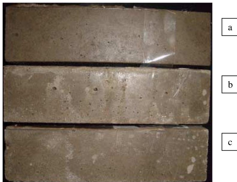
Figura 32: Aspecto dos cp's do material "10 – E", base orgânica, fabricante D, (a) sem ataque e (b, c) submetidos à solução de ácido láctico. Percebe-se a integridade dos cp's após os 5 ciclos de agressão ácida.
