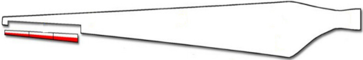
Figura 6.13 - Configuração de Flap na Borda de Fuga da Pá Fonte: (BERG, BARONE e RESOR, 2013)
