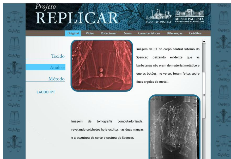
Figura 33 – Detalhe de raios X e tomografia computadorizada realizada em peça de vestuário a ser replicada no Museu Paulista/USP.
