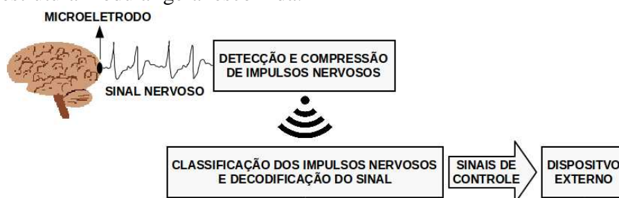
Figura 2. Esquema Geral do Sistema de Interface Cérebro-Máquina
