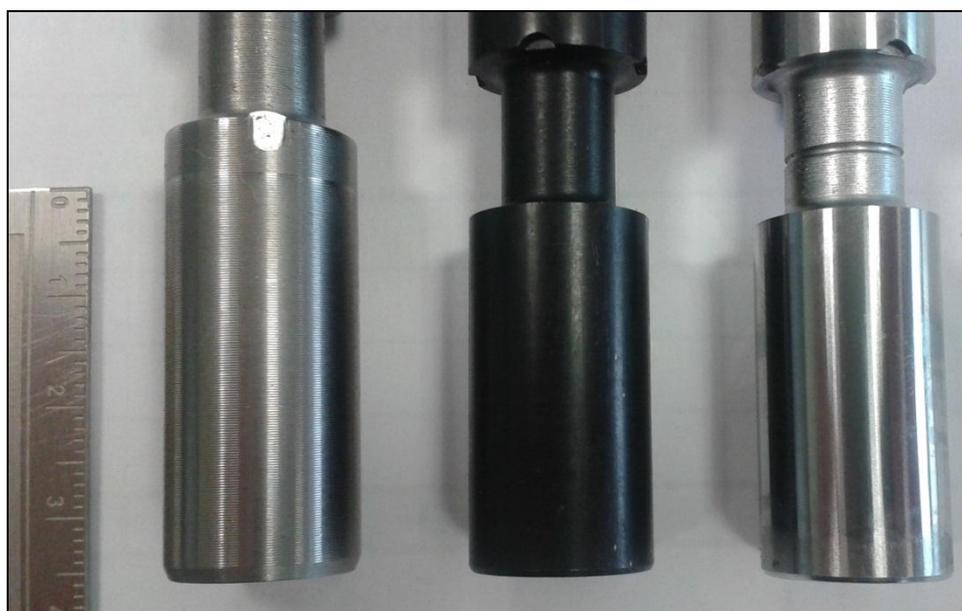
Figura 5.1 Comparação entre amostras da direita para a esquerda comando de válvula cromado, comando de válvula oxinitrocarbonetado e comando de válvula sem revestimento.
