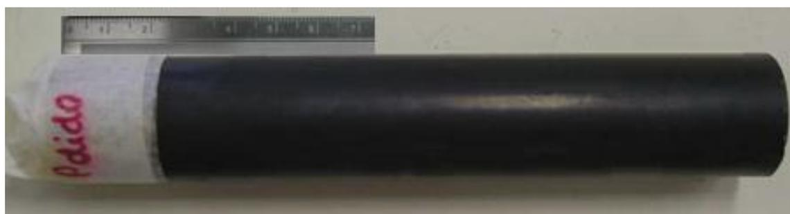
Figura 3.5 Modelo do corpo de prova cilíndrico para o ensaio de névoa salina
