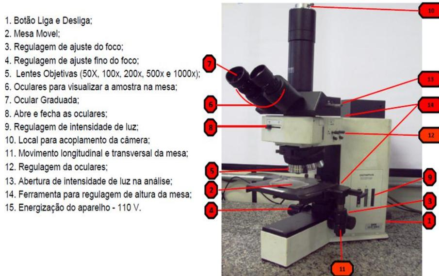
Figura 3.6 Microscópio Ótico Marca Olympus.
