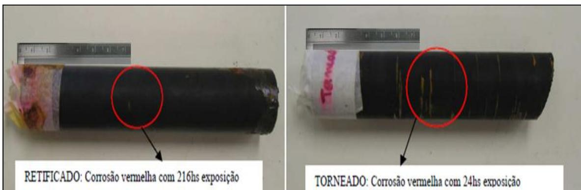
Figura 4.9 (a) Corpo de Prova Retificado com início de corrosão vermelha em 216 hs com pontos em geral, (b) Corpo de Prova Torneado, teve início de corrosão vermelha em 24 hs em pontos em geral.
