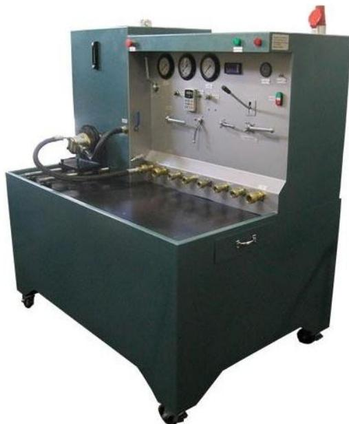
Figura 3.9 Bancada de teste utilizada para avaliar o funcionamento dos comandos de válvula.
