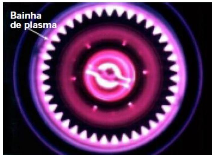
Figura 2.4 Brilho característico de uma peça submetida à nitretação iônica (Fonte: Pinedo, 2004).
