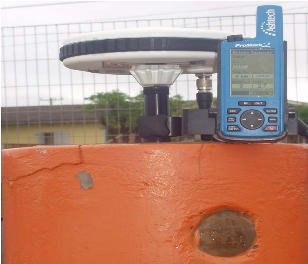
FIGURA 3.4 – Antena e GPS Topográfico acoplados à Estação Base em Osório (RS)
