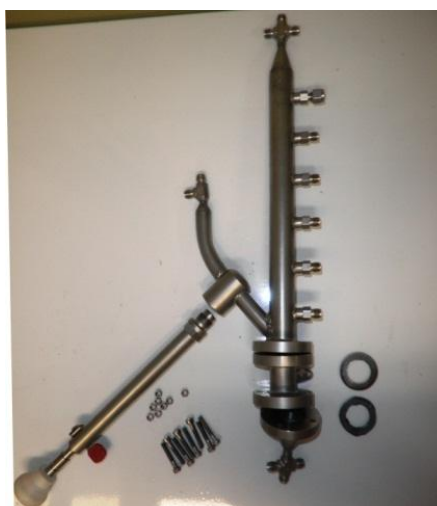
Figura B5: Reator de pirólise rápida com aquecimento resistivo e componentes.
