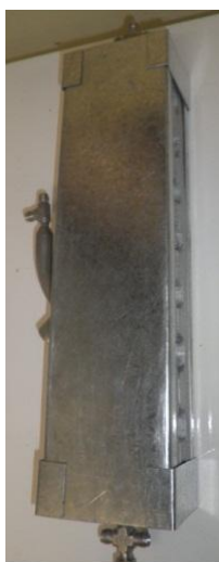
Figura B6: Sistema de isolamento térmico do reator de pirólise rápida com aquecimento resistivo.
