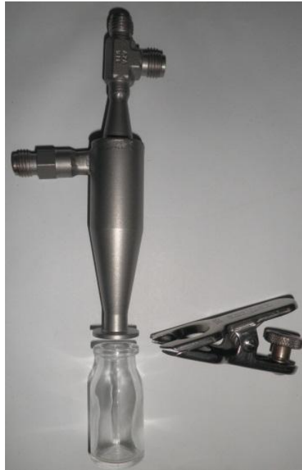
Figura B11: Ciclone Lapple com conexões, coletor e junta de fixação.
