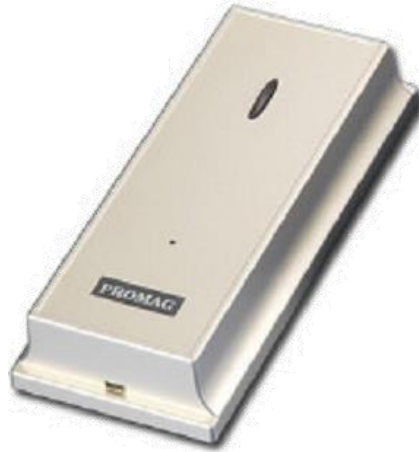
Figura 33 Leitor RFID GP25A LF da Promag utilizado no projeto (PROMAG, 2009).
