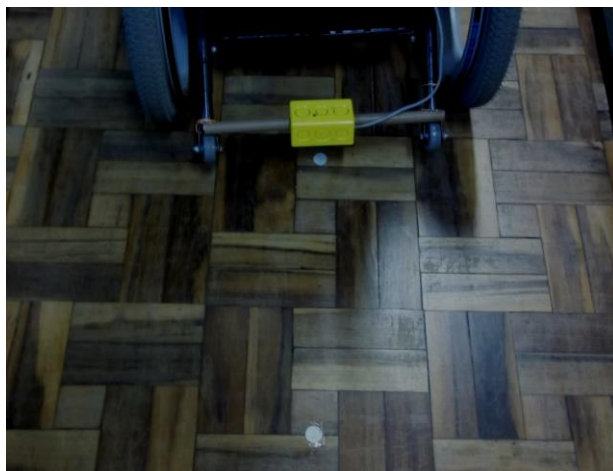
Figura 83 Leitor RFID instalado na cadeira de rodas e as etiquetas fixadas ao chão.
