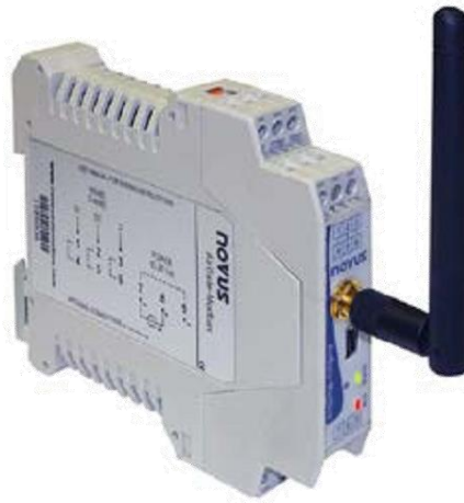
Figura 31 Módulo AirGate-Modbus da Novus (NOVUS, 2013).
