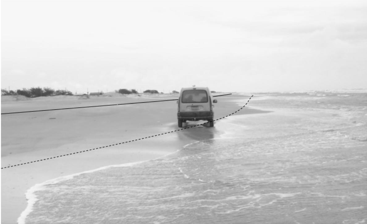
Figura 2: Levantamento longitudinal do perfil de praia utilizando o sistema de posicionamento global (GPS). As linhas marcam a trajetória do monitoramento; linha tracejada – a linha d'água associada ao espraiamento da onda; linha contínua – entre a duna frontal e a linha d'água.
