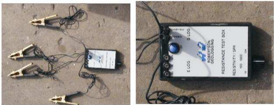
Figura 2.18: Caixa com valores de resistividade padrão para a calibração.
