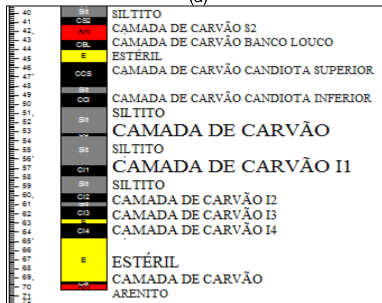
Figura 4.4 (a) e (b): Seção Estratigráfica – Jazida de carvão Candiota/Bloco Seival.
