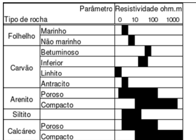
Figura 2.9: Respostas de perfilagem geofísica para algumas litologias (valores em ohm-m) (Oliveira, 2005).
