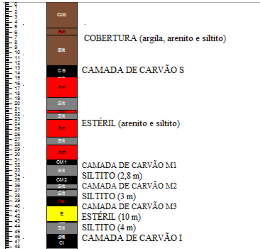
Figura 4.3: Perfil geológico típico observado na ÁREA CERRO. (Obs: o estéril que está representado com aproximadamente 3 m possui, em média, 10 m).
