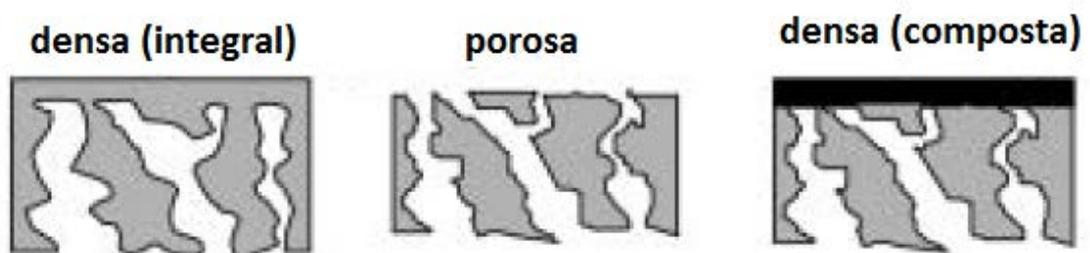
**Figura 2.11:** Representação da estrutura de membranas anisotrópicas (adaptado de Habert *et al.* (2006)).
