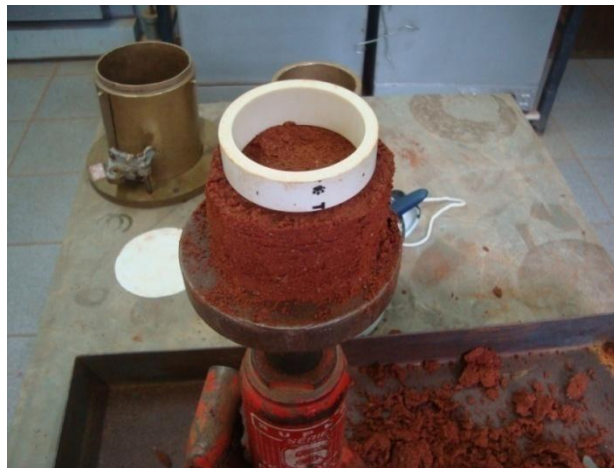
Figura 3.6 – moldagem do corpo de prova
