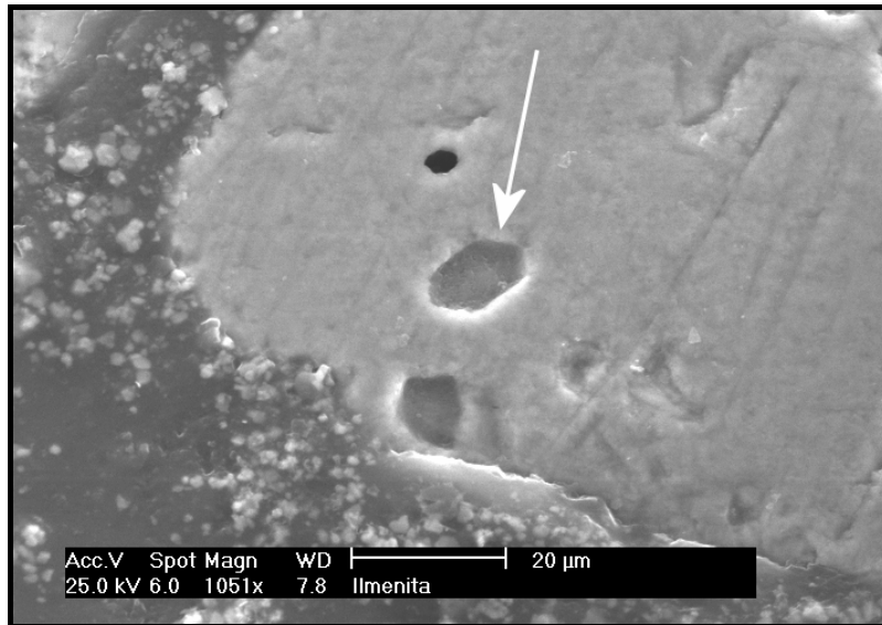
Figura 10. Imagem do MEV de um vazio deixado por uma inclusão bipiramidal em um grão de ilmenita.
