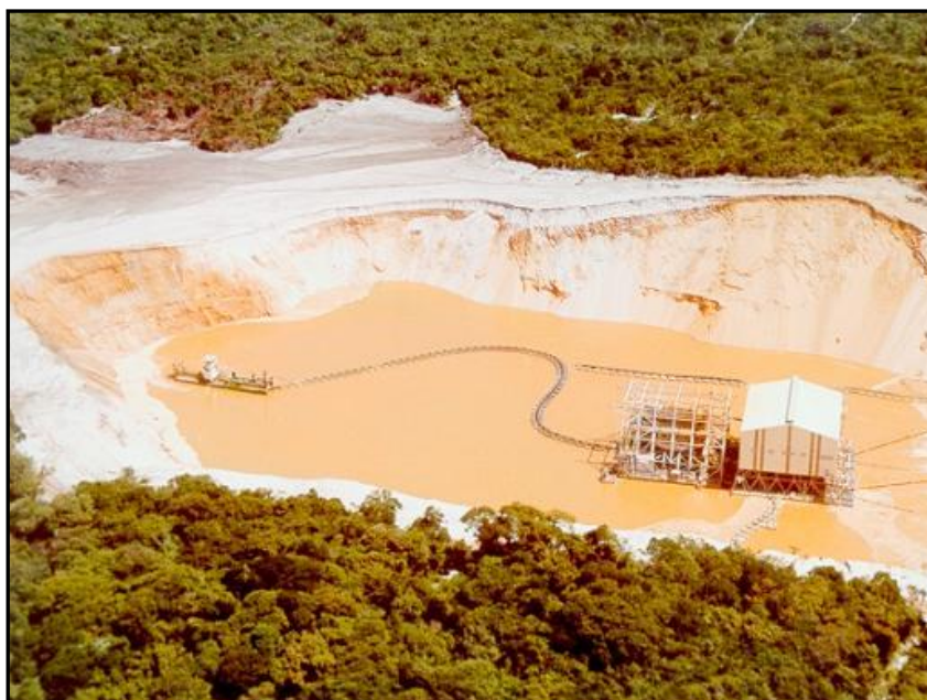
Figura 2. Lavra da Mina do Guaju por draga acoplada com a planta móvel de pré-tratamento.
