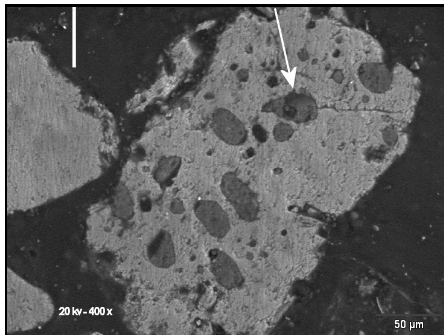
Figura 21. Imagem do MEV de várias inclusões de quartzo em um grão de ilmenita.
