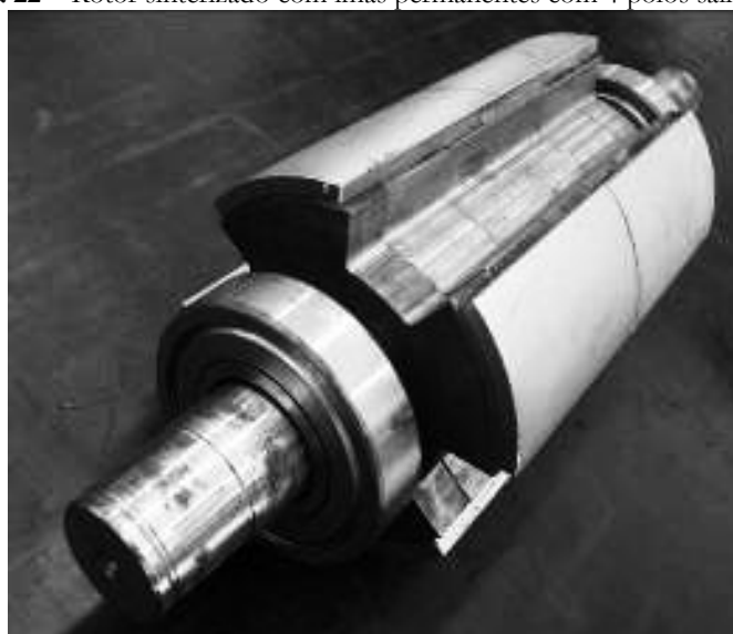
Figura 22 – Rotor sinterizado com ímãs permanentes com 4 polos salientes).
