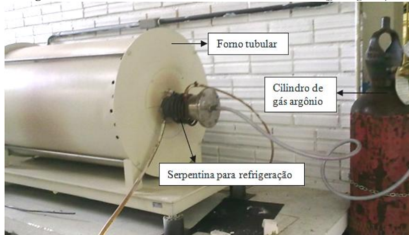
Figura 26 – Forno tubular utilizado com atmosfera inerte (gás argônio).
