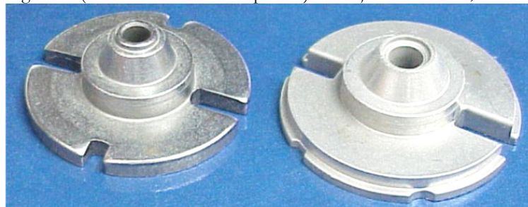
Figura 12 – Núcleo magnético (solenóide de motor de partida): 1º forjado + usinado; 2º sinterizado (esq. para dir.)
