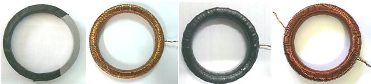
Figura 29 - Peça sinterizada com isolamento (filme de PVC), bobinamento secundário, isolamento novamente e bobinamento primário. Sequencia: da esquerda para a direita.
