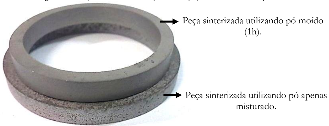
Figura 42 – Peça sinterizada obtida por M.A e peça sinterizada obtida por mistura.
