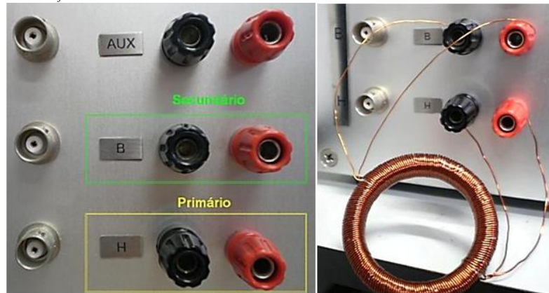
Figura 30 – Traçador de curva de histerese e detalhes da conexão dos fios da bobina completa.
