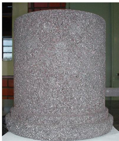
Figura 10 – Câmara de grafite utilizada nos experimentos.
