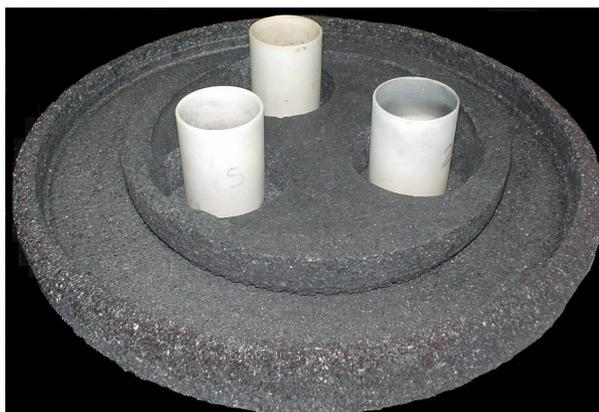
Figura 8 – Cadinhos de alumina utilizados nos experimentos de redução.
