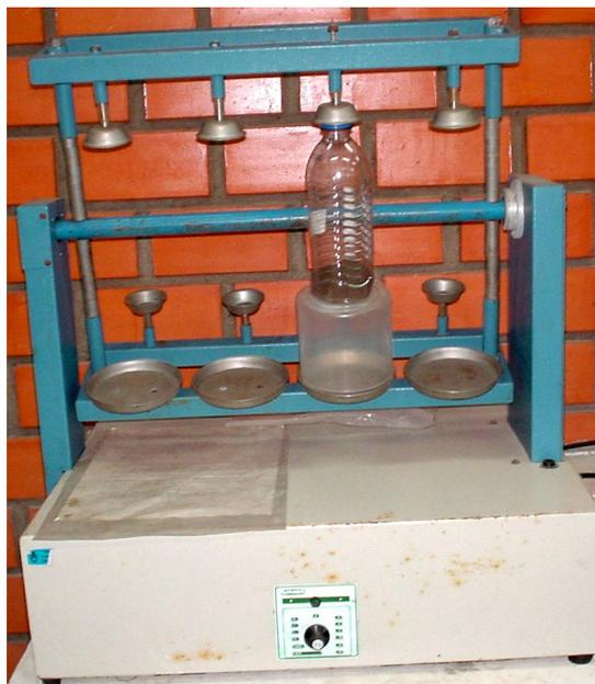
Figura 7 – Equipamento utilizado para homogeneização da mistura de PAE + carvão.
