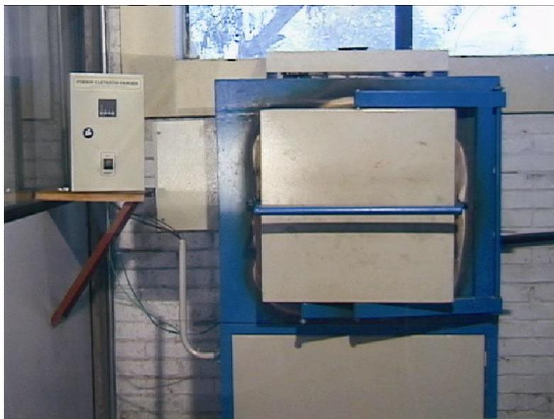
Figura 11 – Forno elétrico utilizado nos experimentos de redução.
