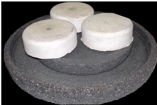
Figura 9 – Tampas de alumina utilizadas nos experimentos de redução.
