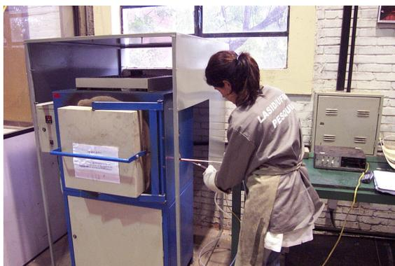
Figura 14 – Retirada do termopar e tubo com  $N_2$  da câmara.
