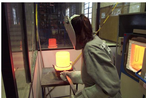
Figura 16 – Colocação da câmara em bancada para início do resfriamento.
