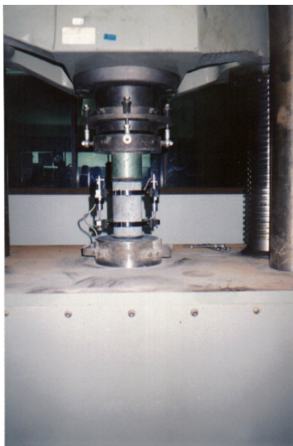
Figura 4.9 - Ensaio de corpo-de-prova de concreto instrumentado para leitura de cargas e deformações
