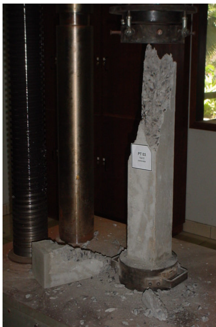
Figura 5.6 - Ruptura do pilar testemunho PT 03
