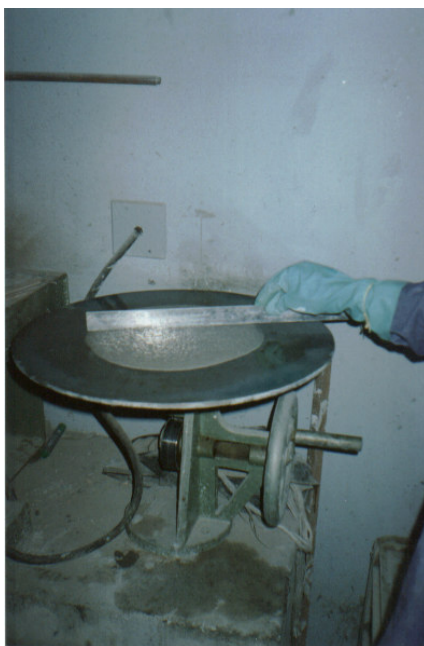
Figura 4.17 - Determinação do índice de consistência da argamassa
