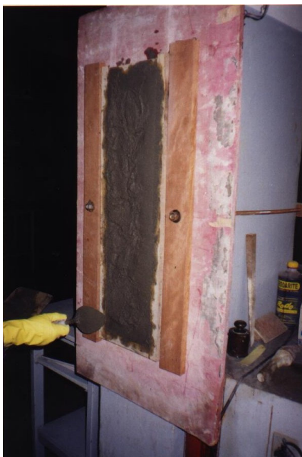
Figura 3.2 - Aplicação da argamassa na placa
