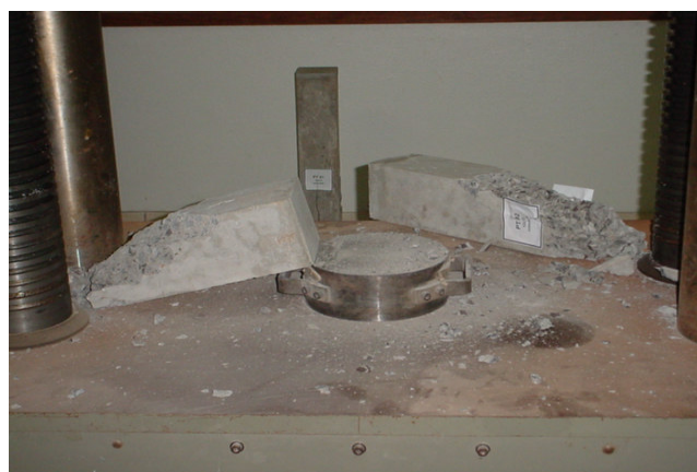
Figura 5.5 - Ruptura do pilar testemunho PT 02
