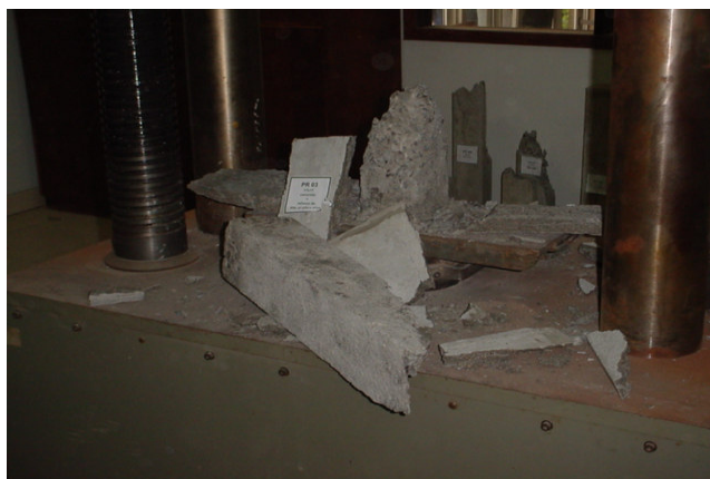
Figura 5.9 - Ruptura do pilar reforçado PR 03
