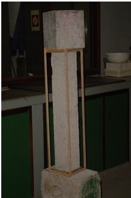
Figura 4.19 - Pilar pronto para receber argamassa de reforço
