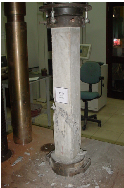
Figura 5.4 - Ruptura do pilar testemunho PT 01
