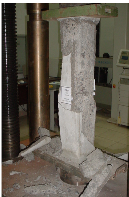
Figura 5.7 - Ruptura do pilar reforçado PR 01
