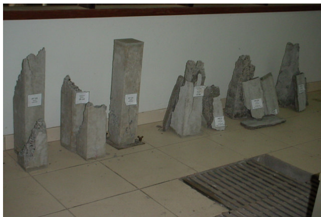
Figura 5.10 - Vista geral dos pilares após ruptura
