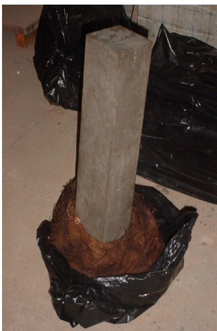
Figura 4.5 – Pilar sendo envolvido por saco de aniagem úmido e saco plástico para cura
