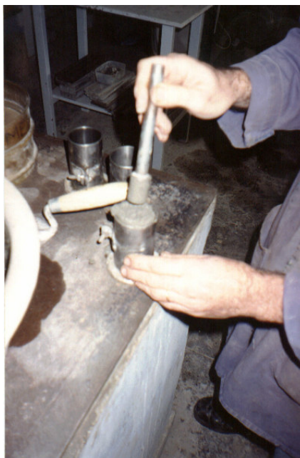
Figura 4.18 - Moldagem dos corpos-de-prova de controle da argamassa de reforço
