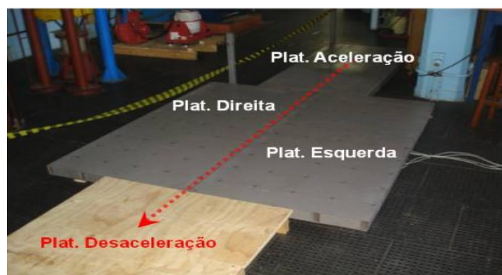
Figura 5.1 – Montagem das plataformas.
