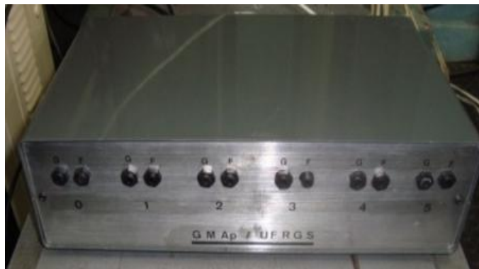
Figura 3.17 – Vista externa do condicionador/amplificador de sinais construído.
