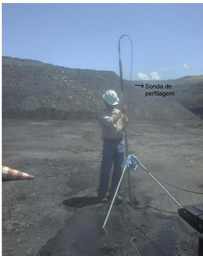
Figura 2.6- Sonda de perfilagem sendo introduzida no furo. Fonte: Oliveira et al. (2004).
