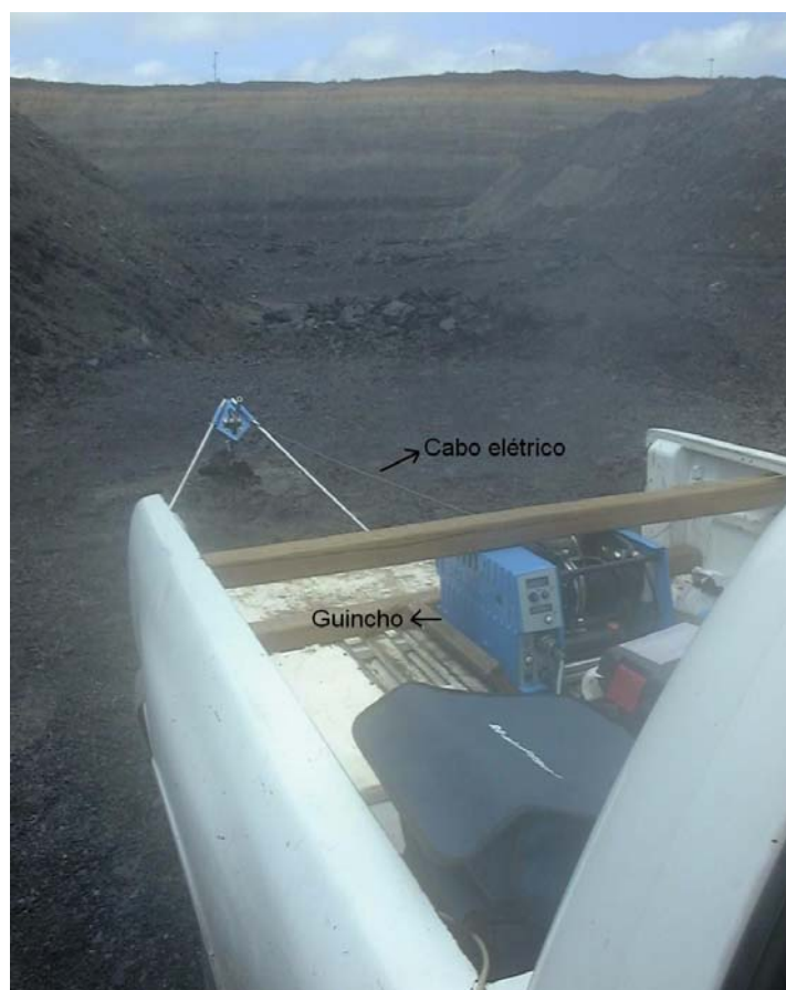
Figura 2.8- Guincho segurando a sonda de perfilagem. Fonte: Oliveira et al. (2004).
