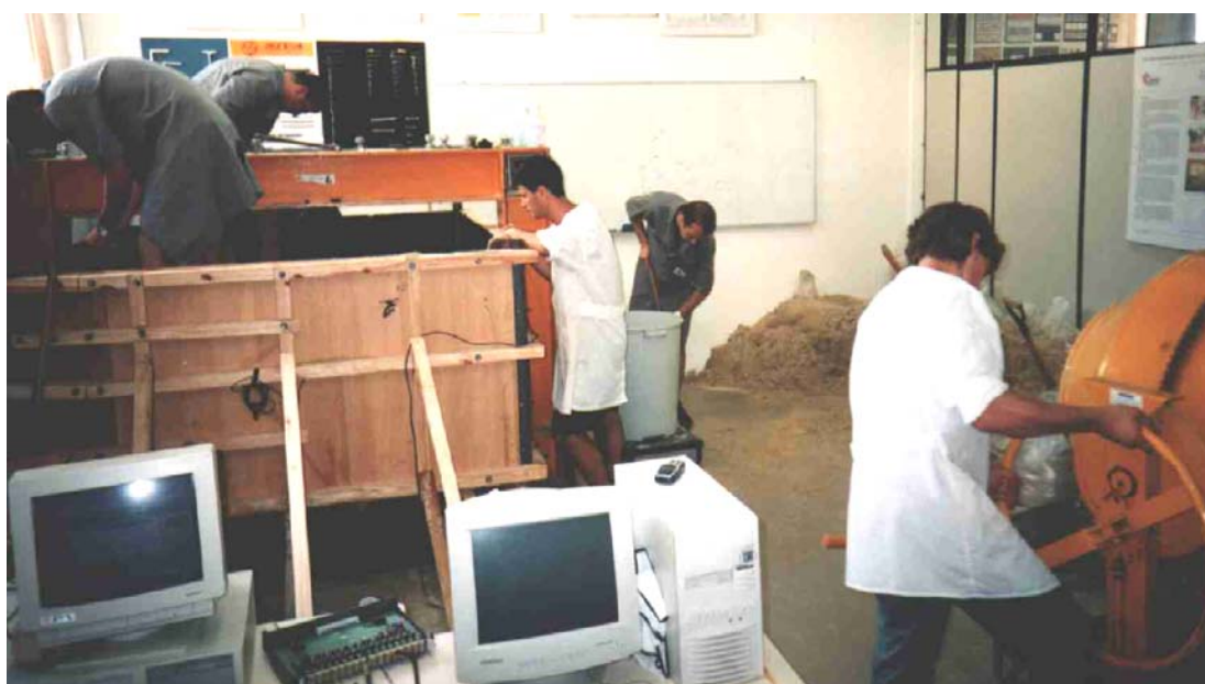
Figura 3.13: Detalhe do ambiente de execução dos ensaios de placa.
