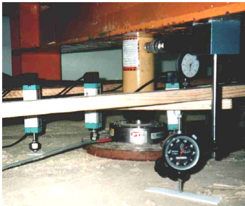
Figura 3.15: Detalhe do sistema de medição de deslocamentos
