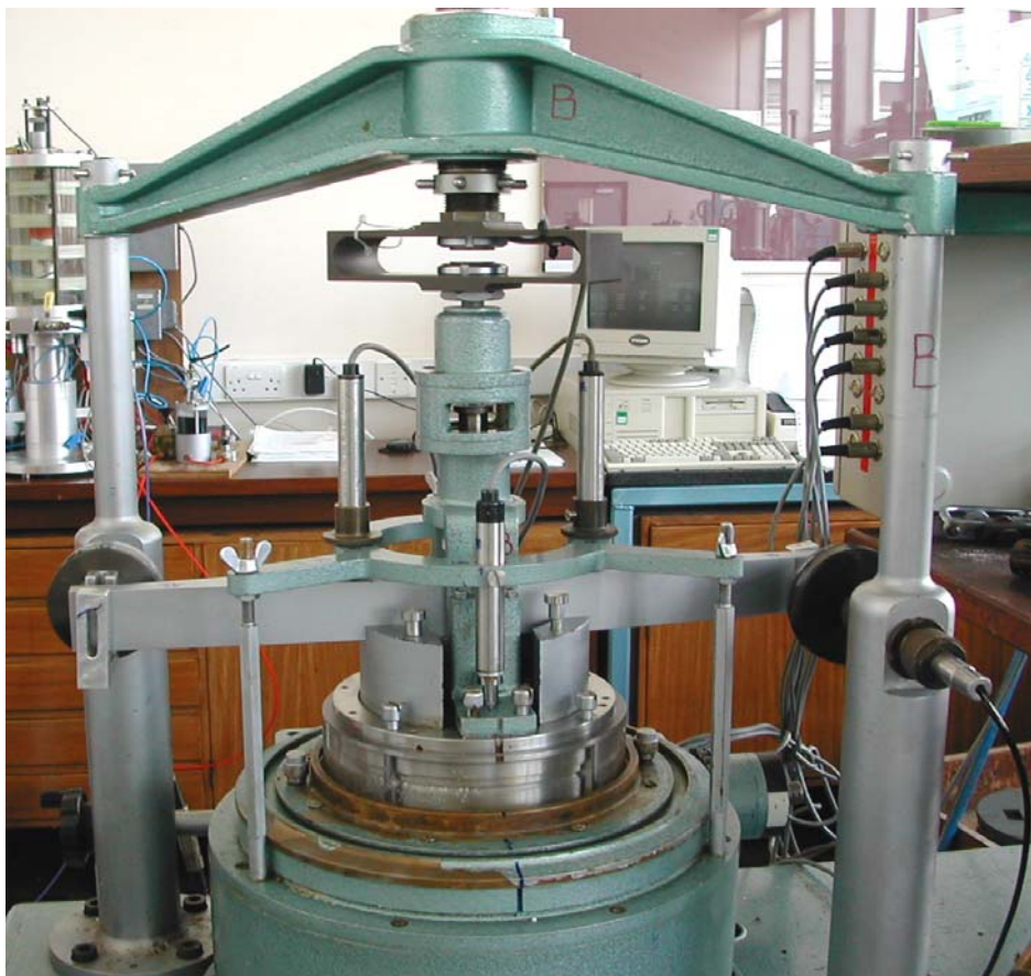
Figura 3.12: Visão geral do equipamento ring shear (Bishop et al , 1971)
