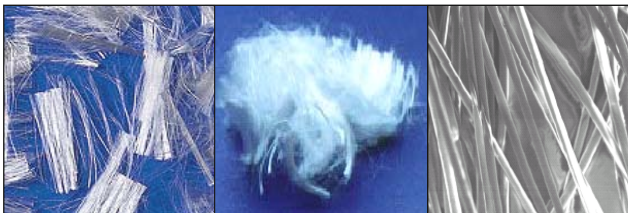
Figura 3.4: Aspecto das fibras de polipropileno com 24 mm de comprimento e imagem de microscopia eletrônica das fibras (aumento de 90x)
