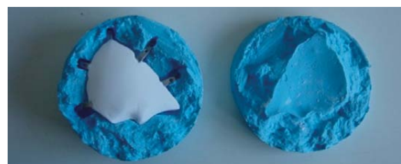
Figura 6. Molde para a fabricação do implante. A tela de titânio fica posicionada no interior e recoberta com cimento de fosfato de cálcio. Figure 6. Mold made to the production of the implant. The titanium mesh in positioned inside the mold and covered with calcium phosphate cement.
