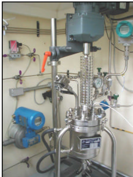
Figura 3.2: Detalhe do reator semi-batelada de bancada.
