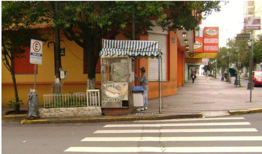
Figura 13 – Exemplo do mobiliário urbano funcionando como barreira para travessia de pedestre e de extensão do passeio
