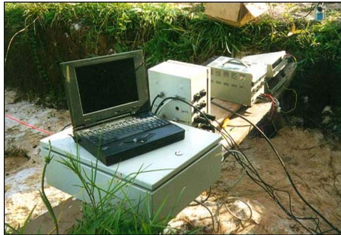
Figura 3.7 – Detalhe do sistema de aquisição de dados.
