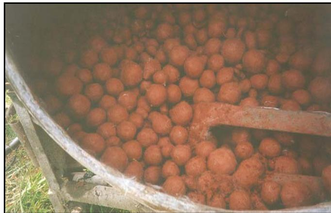
Figura 3.5 – Mistura dos materiais obtida em betoneira.
