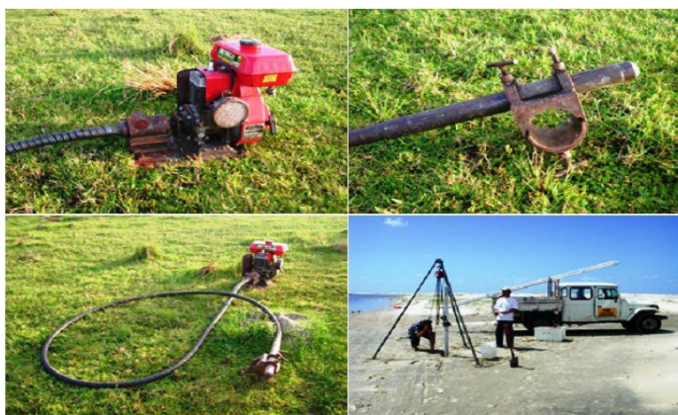
Fig. 16. Principais componentes do sistema de testemunhagem à vibração (motor, mangote, braçadeira, ponteira e tripé (Arejano, 2006).
