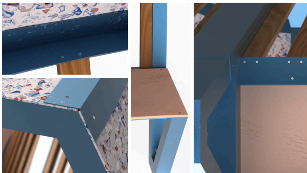
Figura 72: fixação do perfil vedante, assento e ripas
