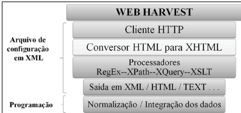
Figura 6: Visão geral da arquitetura da aplicação Web-Harvest .
