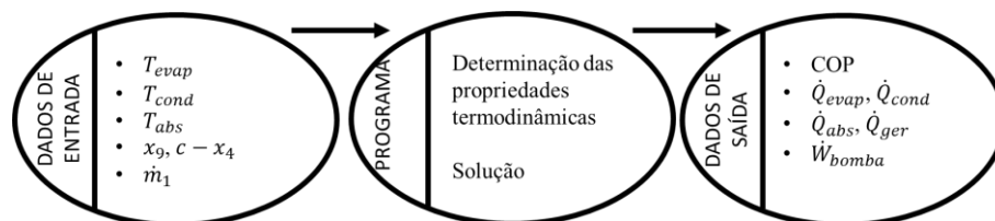
Figura 4: Fluxograma do ciclo termodinâmico implementado no EES.
