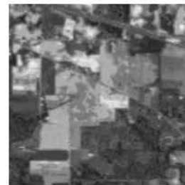
Fig. 2 - Imagem hiperespectral obtida pelo sensor AVIRS. Apresenta-se uma imagem em tons de cinza a 8 bits obtida a partir de uma composição colorida RGB utilizando as bandas correspondentes aos comprimentos de onda 860, 657 e 557 nm.
