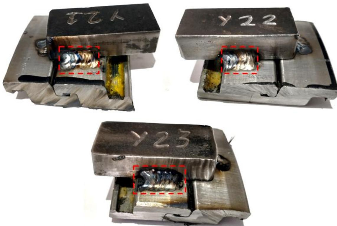
Figura 19 – Inspeção visual das soldas realizadas com corrente de 70 A.
