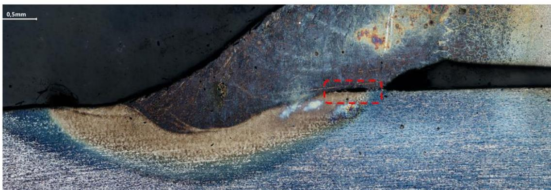
Figura 27 – Metalografia da região 3, amostra Y11. 50x, Nital 2%.
