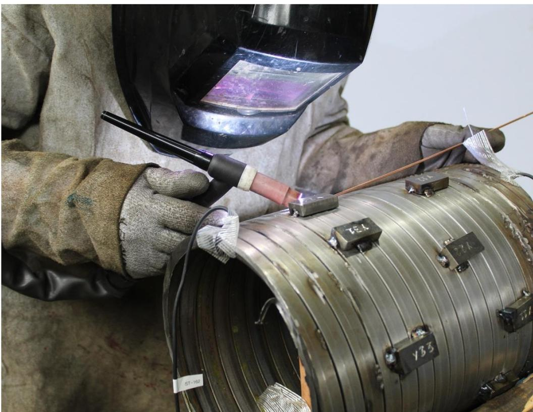
Figura 13 – Soldagem TIG manual dos CPs na Armadura de Pressão.
