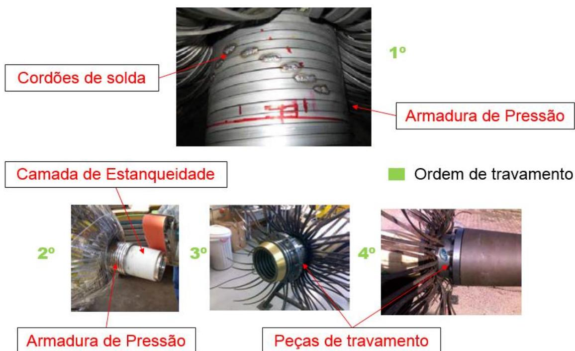
Figura 6 – Processo de travamento da Armadura de Pressão.
