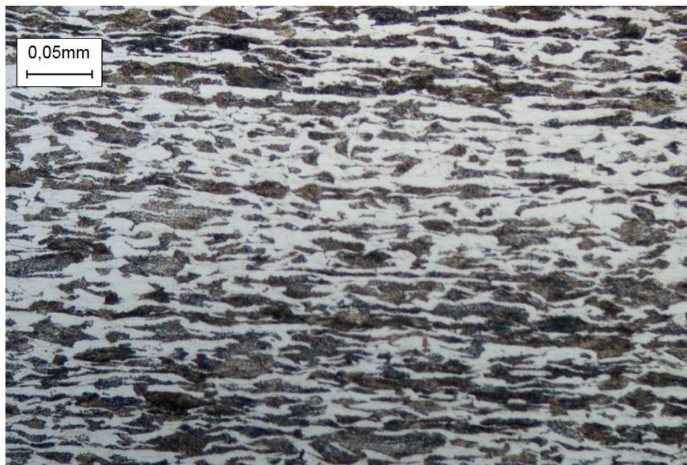
Figura 30 – Metalografia da região 4, amostra Y11. 200x, Nital 2%.
