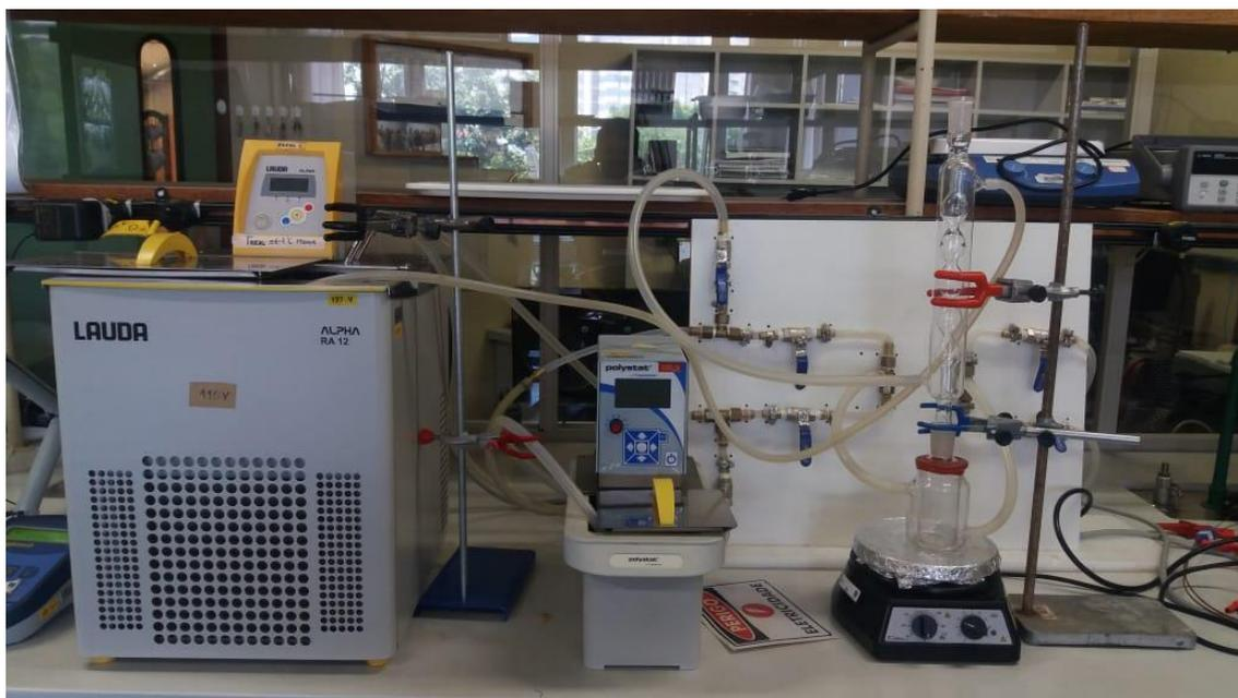
Figura 2: Representação do aparato experimental da extração sólido-líquido
