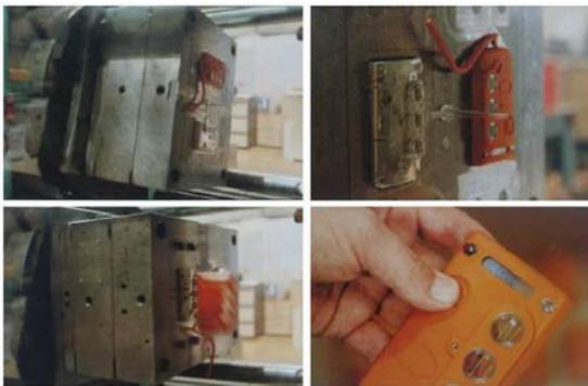
**Figura 9:** Sobre injeção com molde giratório. Fonte: Thompson (2010).
