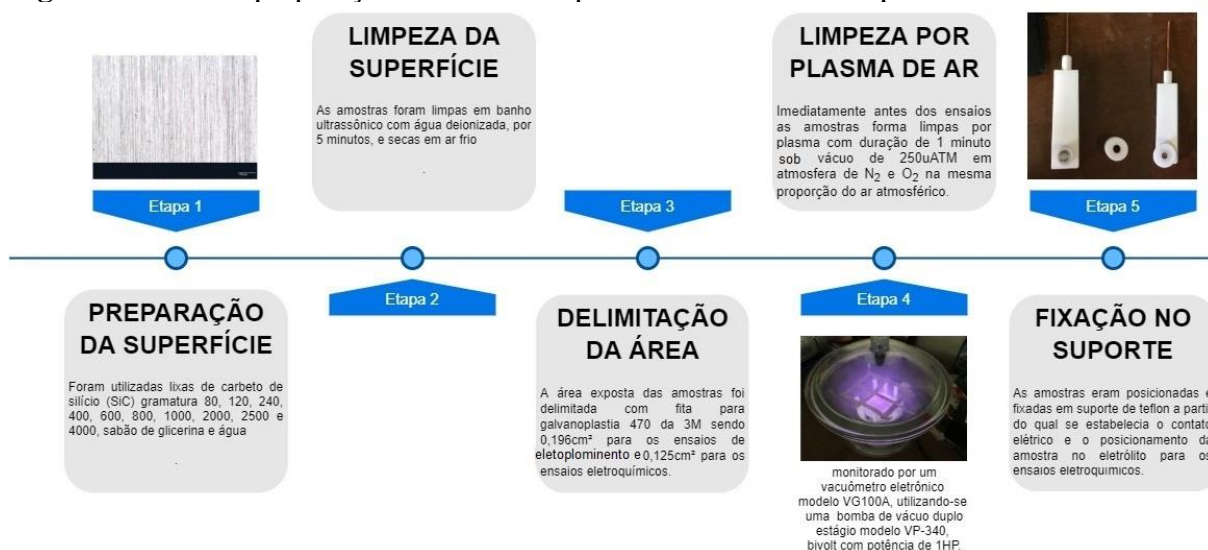
Figura 7 Fluxo de preparação das amostras para os ensaios e eletroquímicos.
