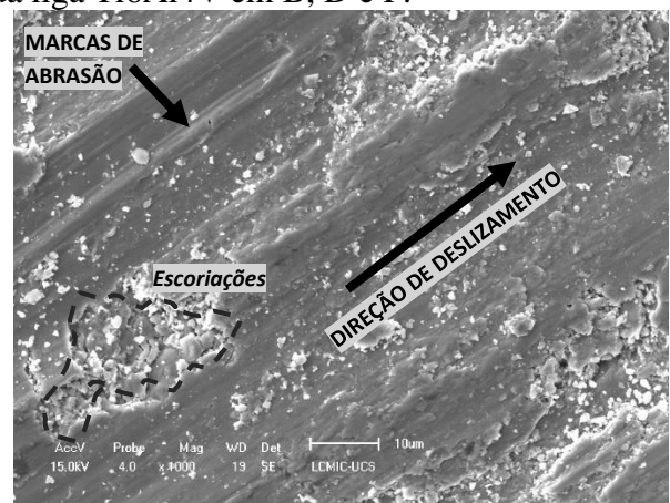
Figura 16 MEV com detalhes do mecanismo de desgaste a seco na região da trilha da liga Ti26Zr24Nb em A, C e E e na região da trilha da liga Ti6Al4V em B, D e F.
