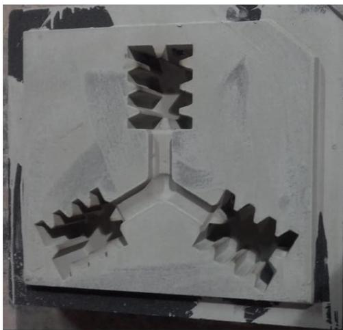
Figura 34 - Molde em areia com resina fenólica uretânica de cura a frio
