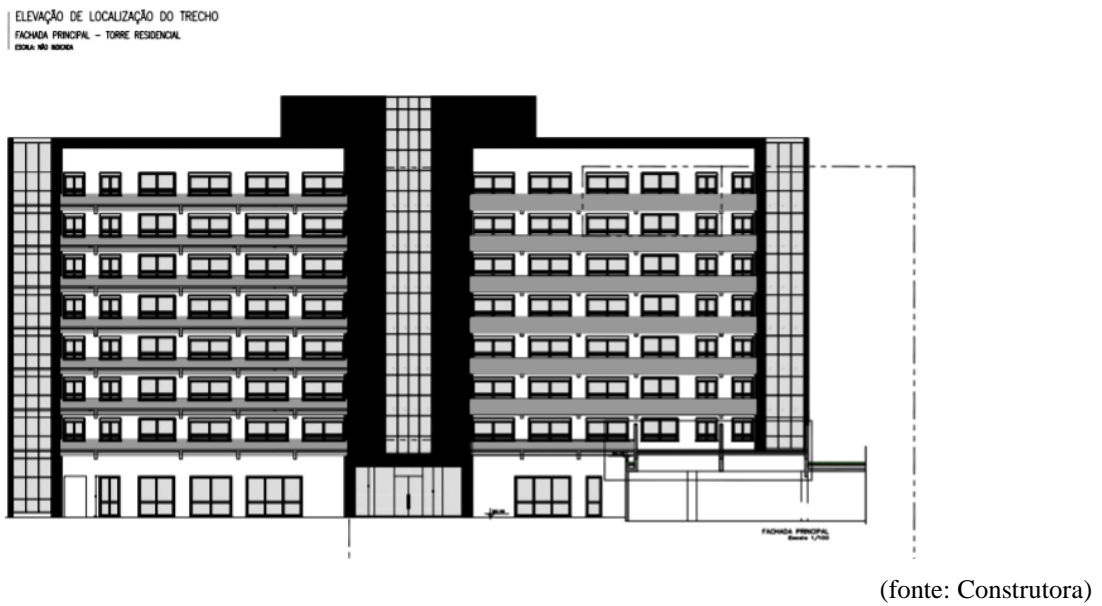
Figura 37: Trecho da fachada – Janelas de correr Estudo preliminar
