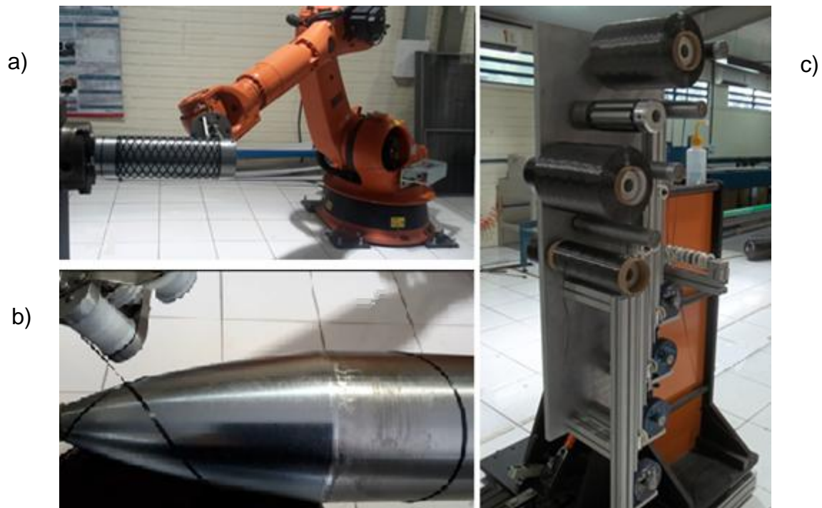
Figura 24. Equipamento de FW: a) robô enrolando o tubo com 150mm com PTR 8/1; b) primeiro circuito do enrolamento da tubeira; c) dispositivo de alimentação das fitas fornecidas em bobinas.
