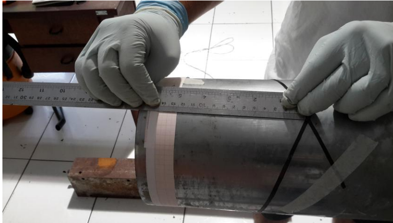
Figura 29. Avaliação do deslocamento angular em função de z em uma superfície cilíndrica.
