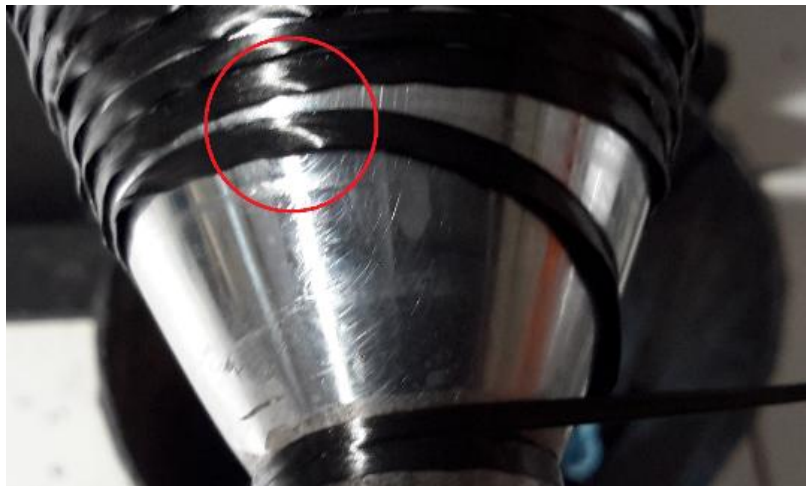
Figura 40. Tubeira com região de escorregamento assinalada.
