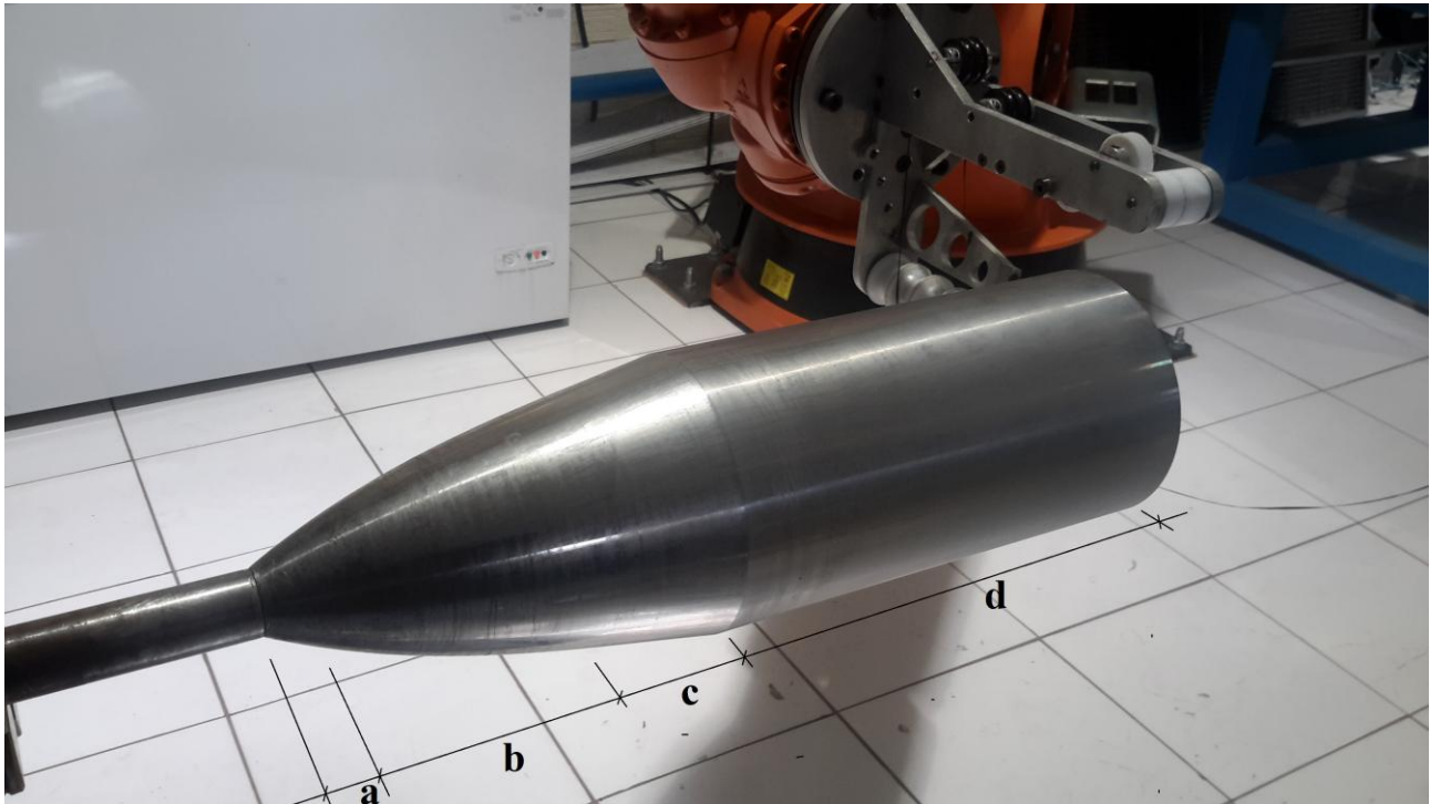
Figura 101. Mandril com extensões: a) e c) da superfície da tubeira, d) cilíndrica, e b) é o comprimento da tubeira.
